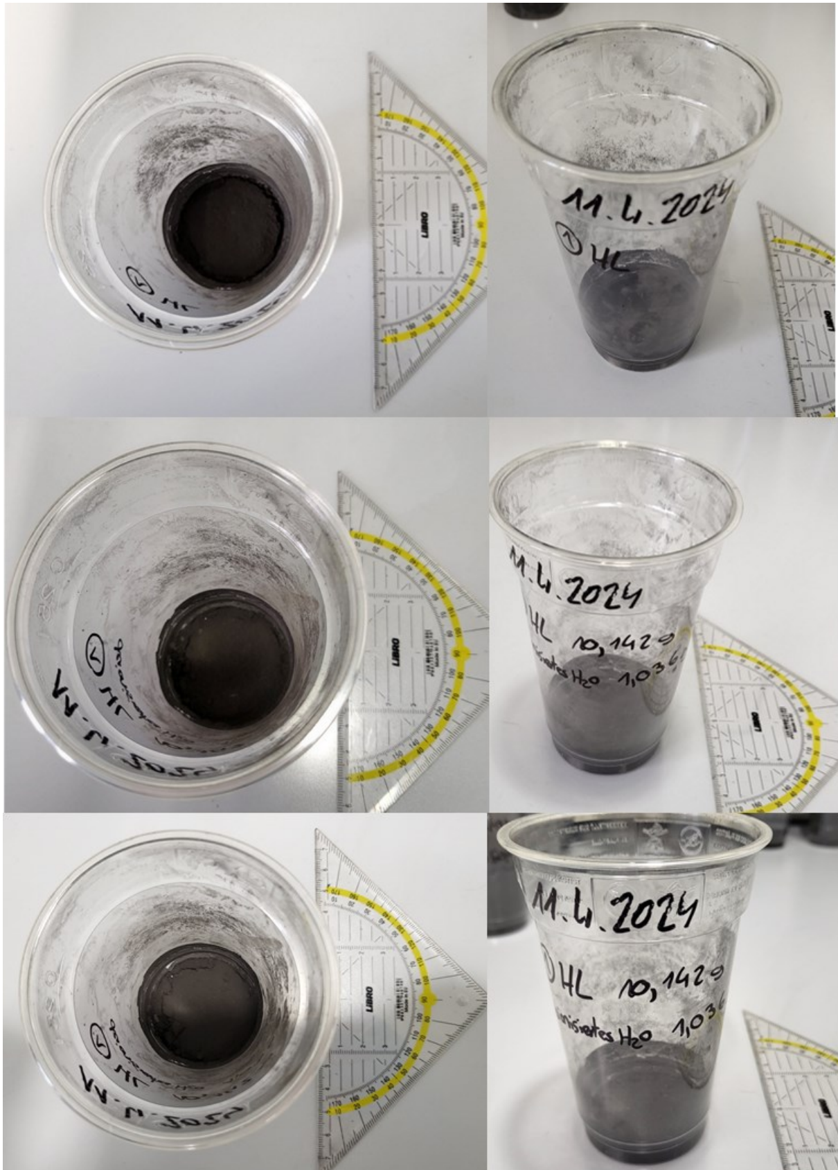
Abbildung 62: HL-Probe 1, oben nach 10 min, Mitte nach 24 h, unten nach 72h
