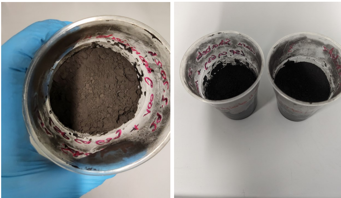
Abbildung 41: Links LFP-Probe nach 1 h rechts LFP-Proben nach 72h
