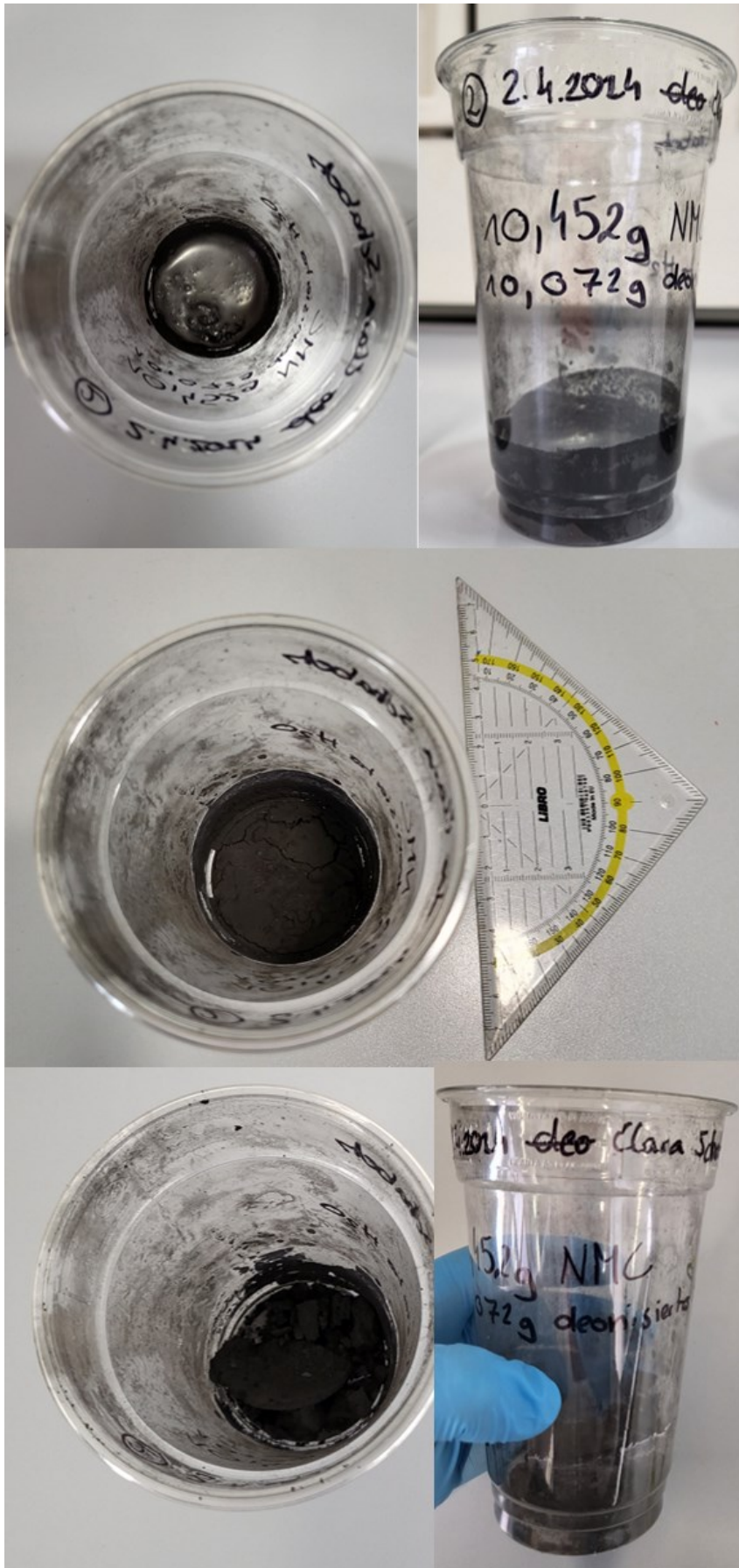
Abbildung 65: NMC-Probe 2, oben nach 10 min, Mitte nach 24 h, unten nach 72h
