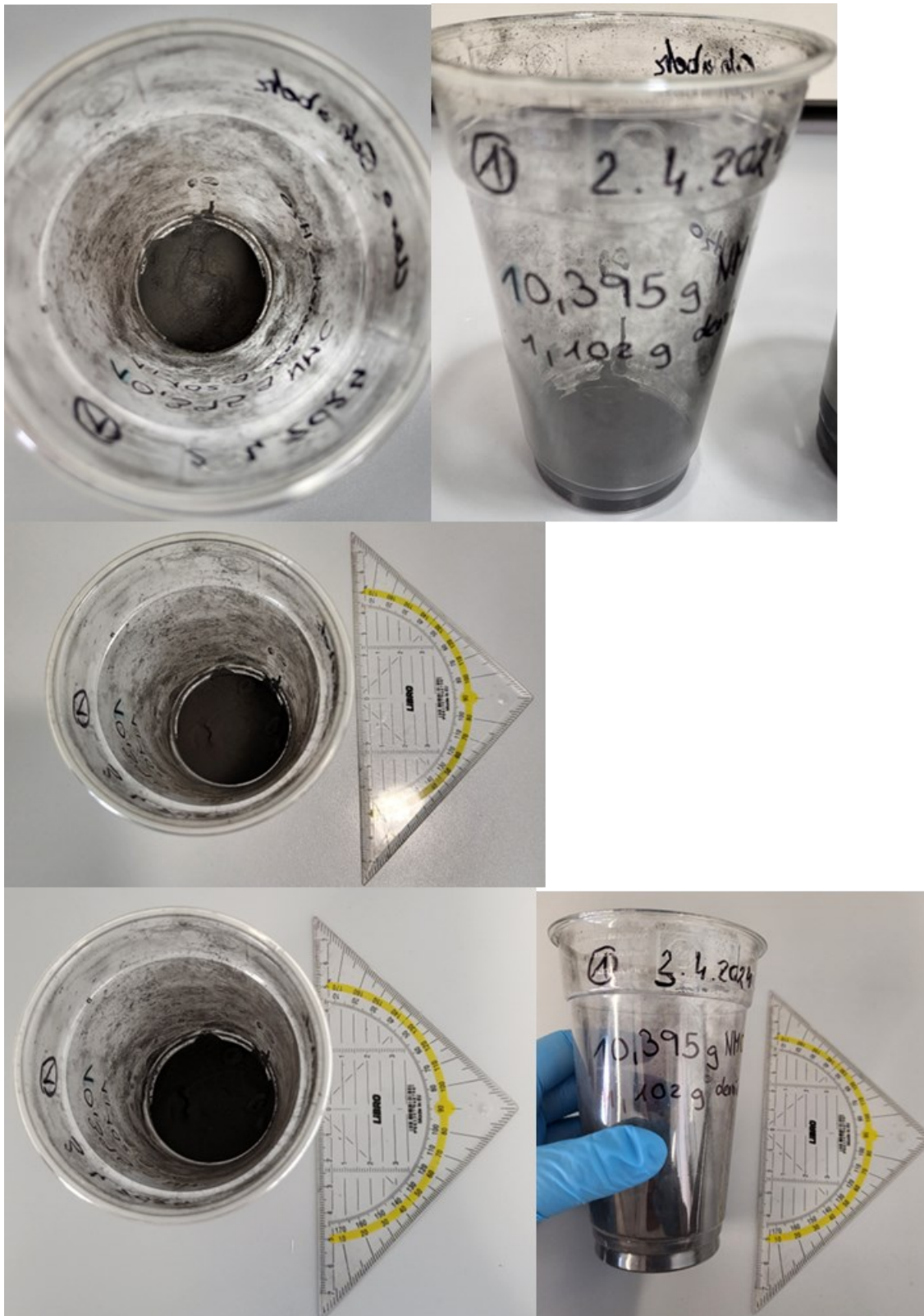
Abbildung 61: NMC-Probe 1, oben nach 10 min, Mitte nach 24 h, unten nach 72h
