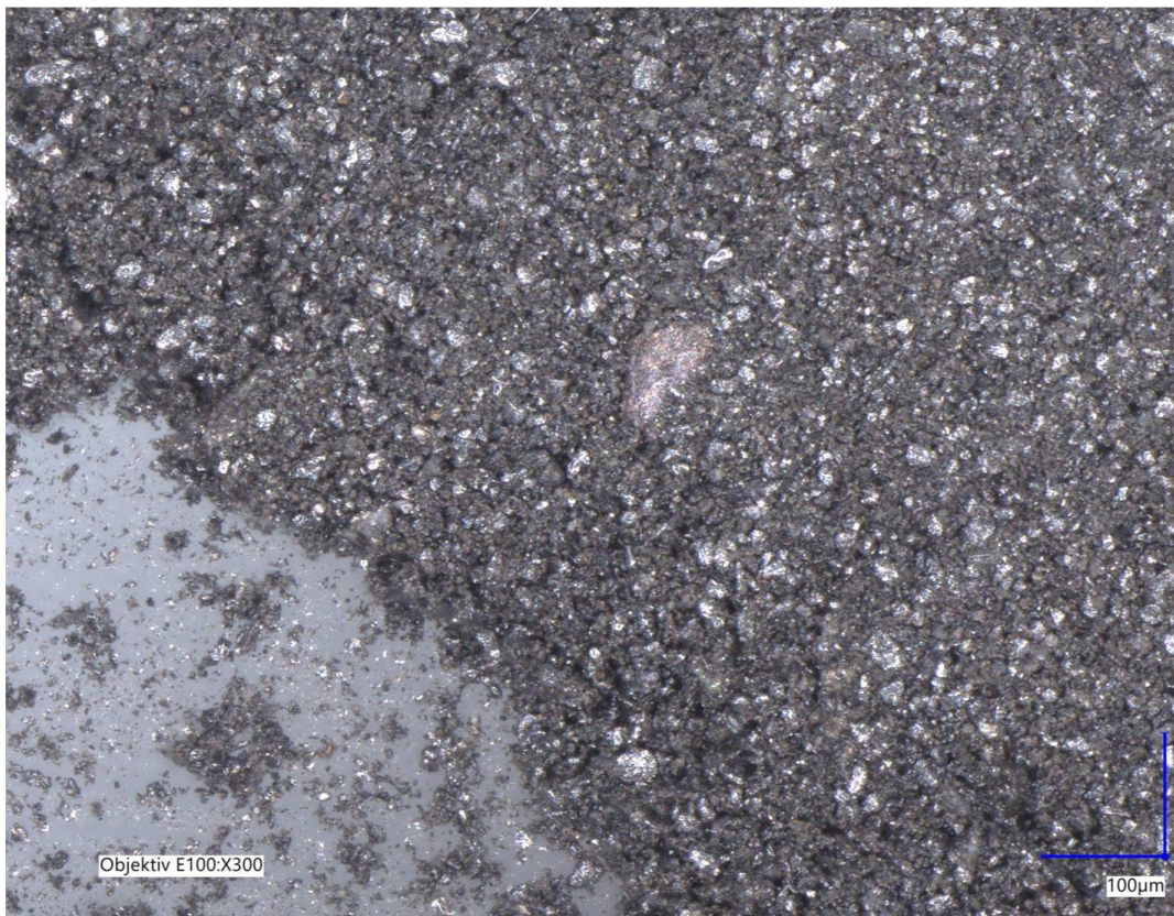
Abbildung 19: Detailansicht NMC 300-fache Vergrößerung
