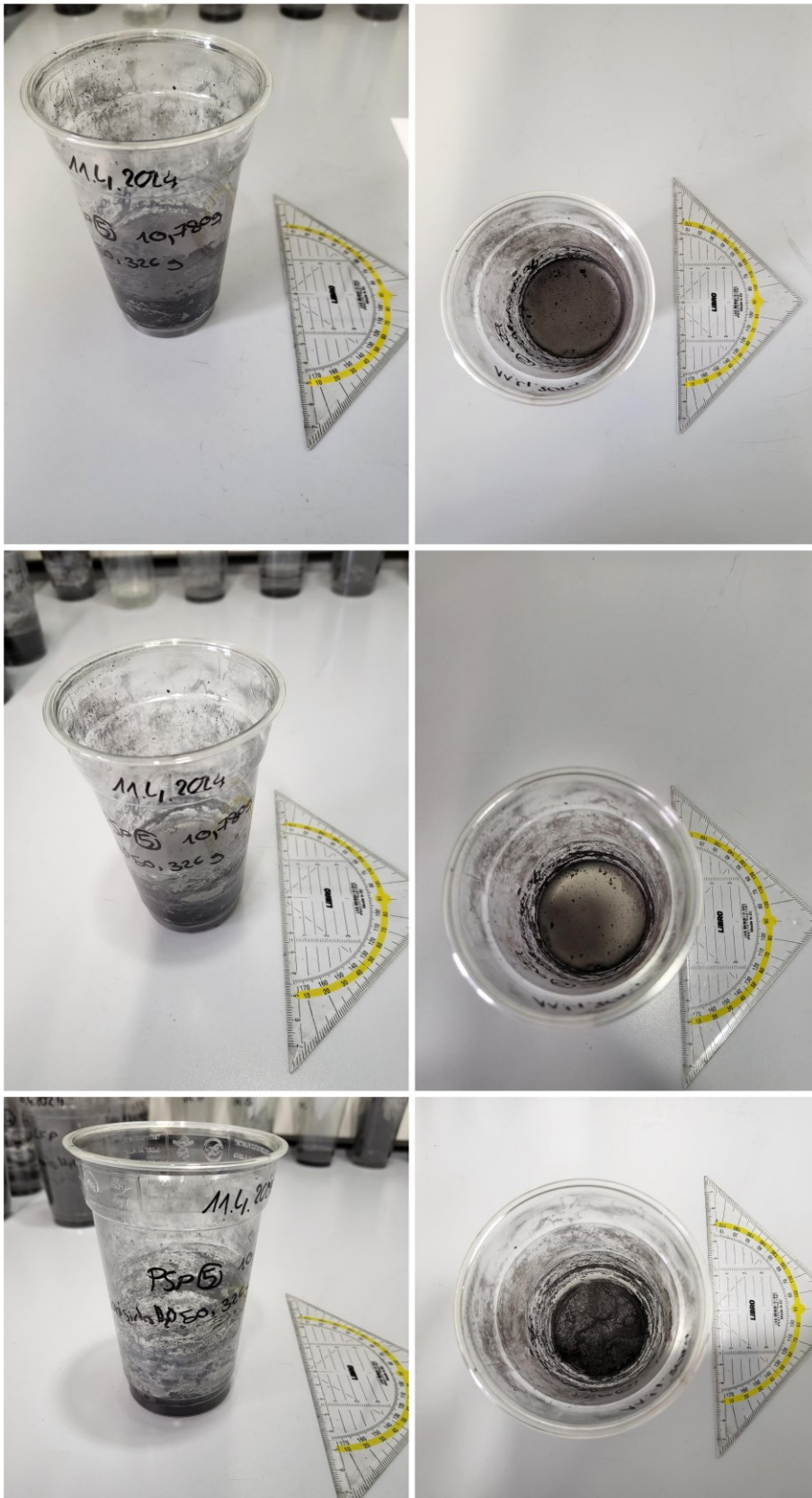
Abbildung 76: PSP-Probe 5, oben nach 10 min, Mitte nach 24 h, unten nach 72h
