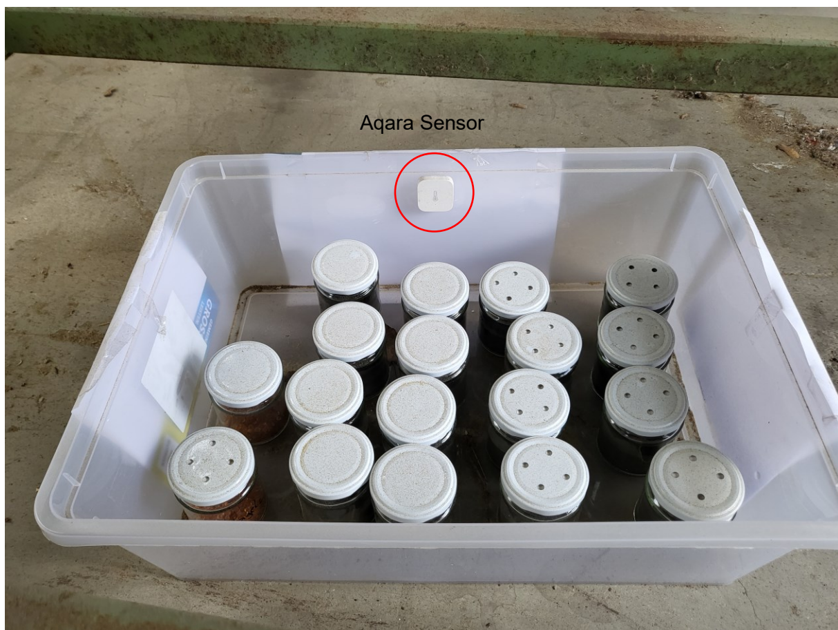
Abbildung 29: Schraubgläser mit Aktivmaterialproben nach 50 Tage Lagerung.
