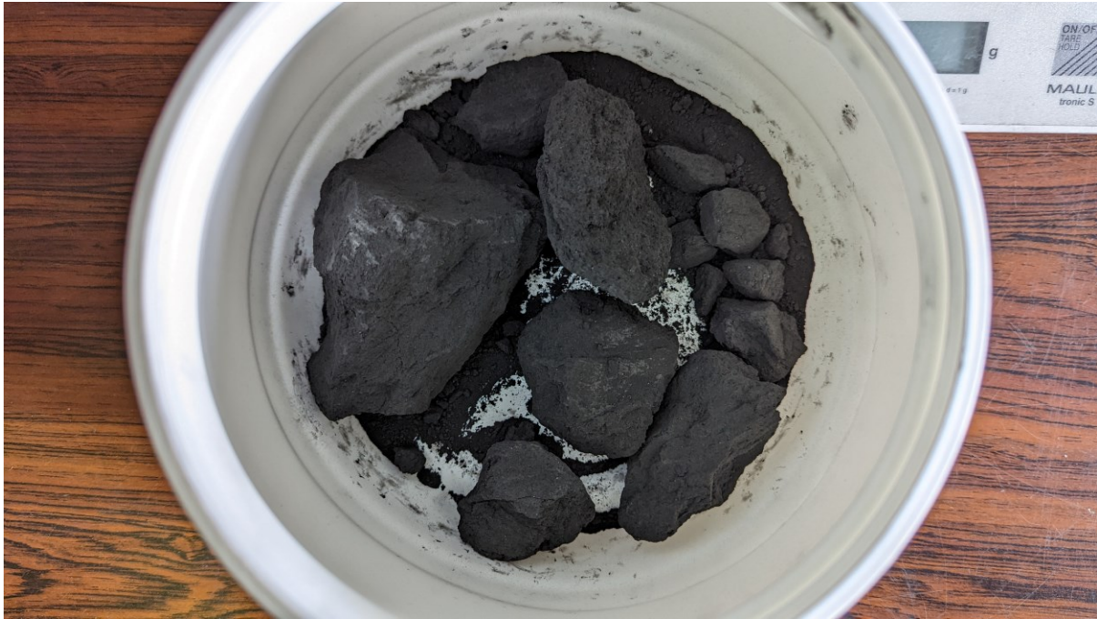
Abbildung 2: Verfestigtes und verklumptes Aktivmaterial aus dem Batterierecycling
