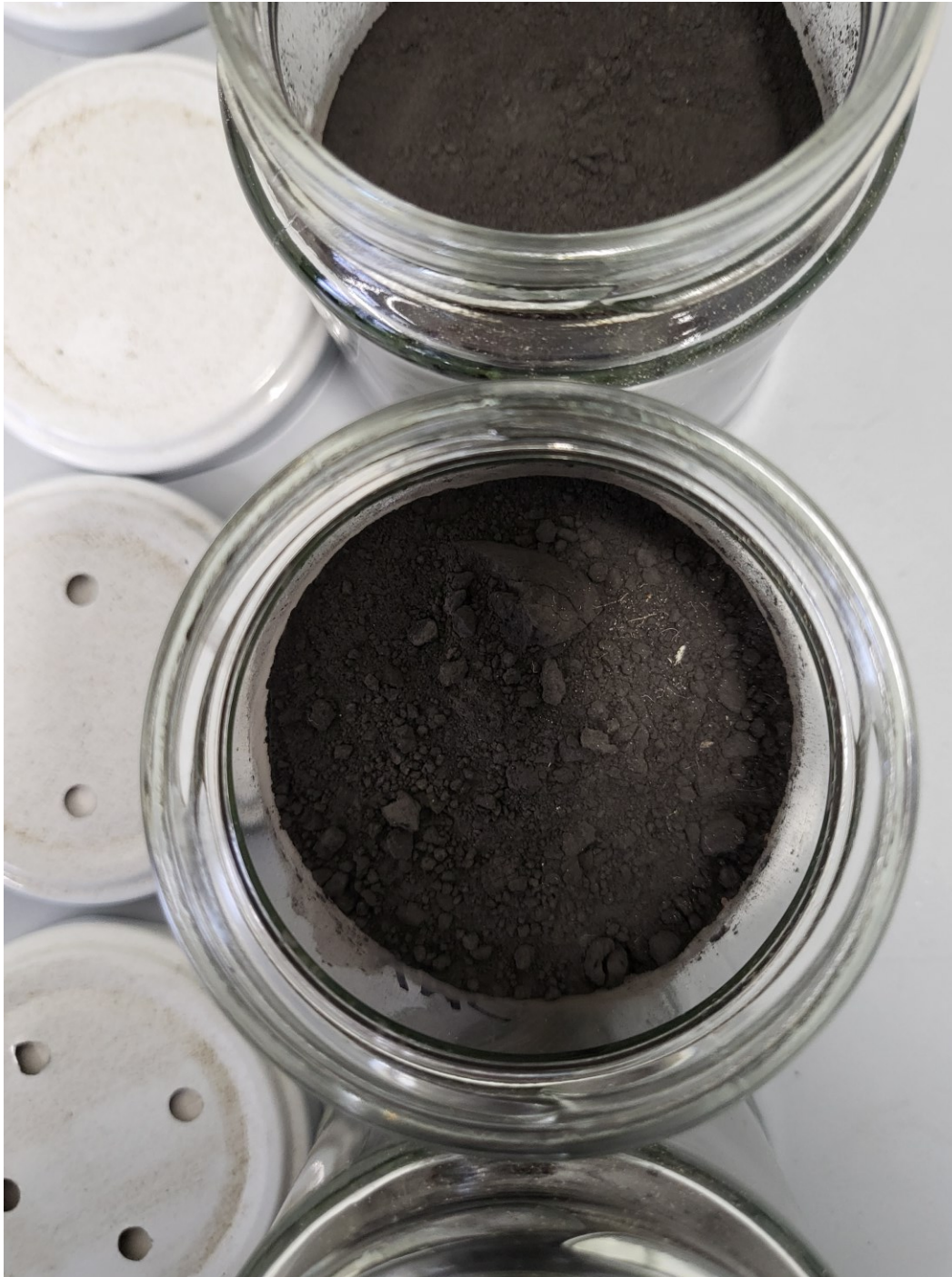
Abbildung 31: Detailaufnahme der elektrostatischen Verklumpungen der NMC – Proben
