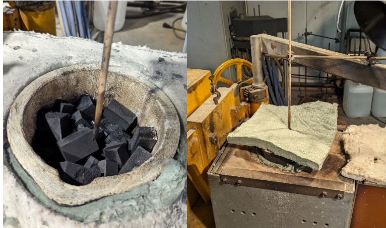
Abbildung 14: Aufschmelzen des kohlenstoffarmen Eisens mit Graphit im Induktionsschmelzofen ITG
