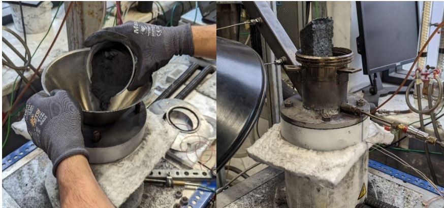
Abbildung 21: Befüllung des Reaktors mit Einsatzstoffen beim Versuchssetup am MU 1200
