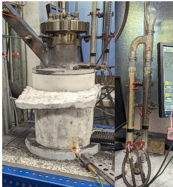
Abbildung 20: Reaktor mit zusätzlicher Spule (links) und Rückflusskühler (rechts) des Versuchsaufbaus am MU 1200
