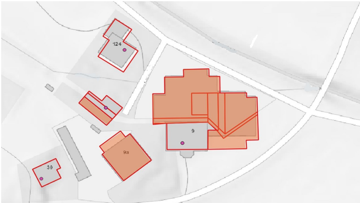
Abbildung 4-11: beispielhaftes Ortsnetz mit fehlerhafter Berechnung der Dachfläche
