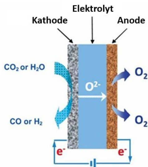
Abbildung 2-4: Aufbau einer SOEC (in Anlehnung an [23]).
