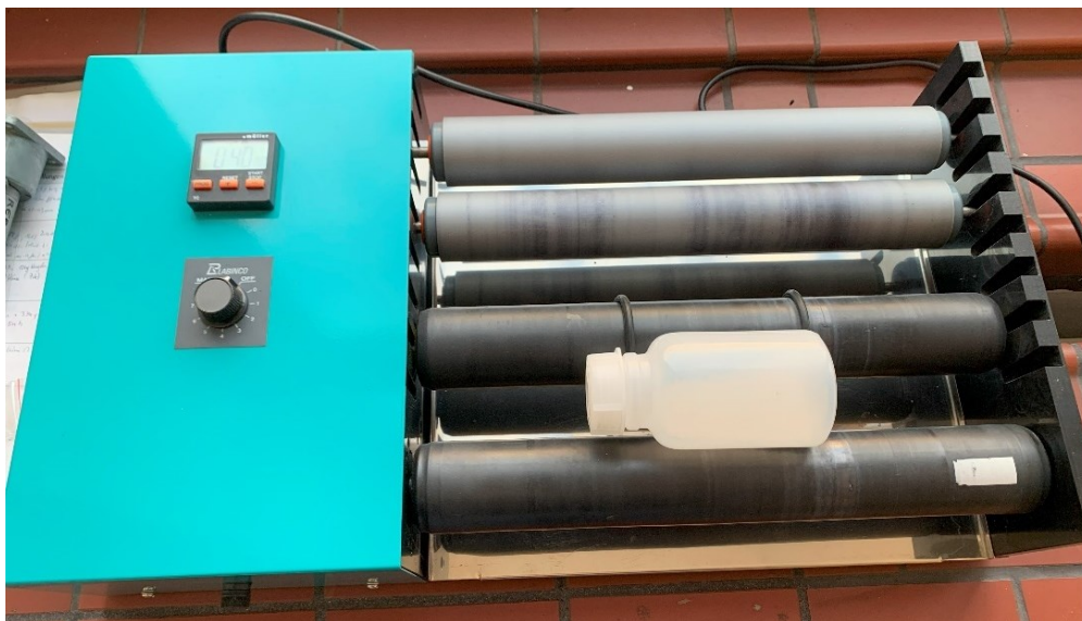
Abbildung 3-3: Rollbank mit PE-Behälter.
