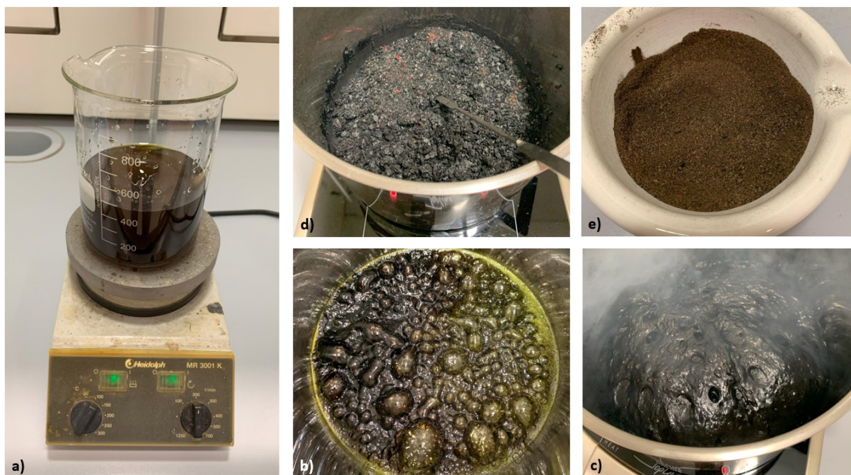
Abbildung 3-2: Synthese von LNF64 mittels Sol-Gel-Verfahren.
