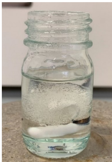
Abbildung 3-4: Terpeneol und PVB-Pulver im Glasgefäß mit Rührfisch.
