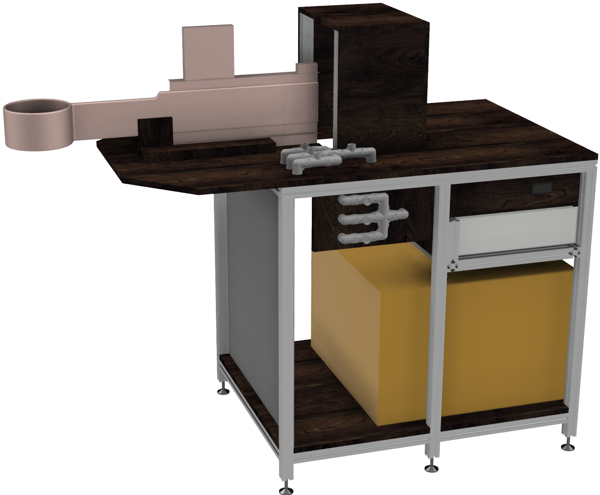
Abbildung 45: Visualisierung der adaptierten Induktionsschmelzanlage am Lehrstuhl für Thermoprozesstechnik.
