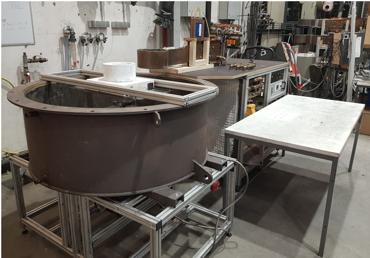
Abbildung 48: Fotografie der fertiggestellten Rotationszerstäubung und der umgebauten Induktionsschmelzanlage.
