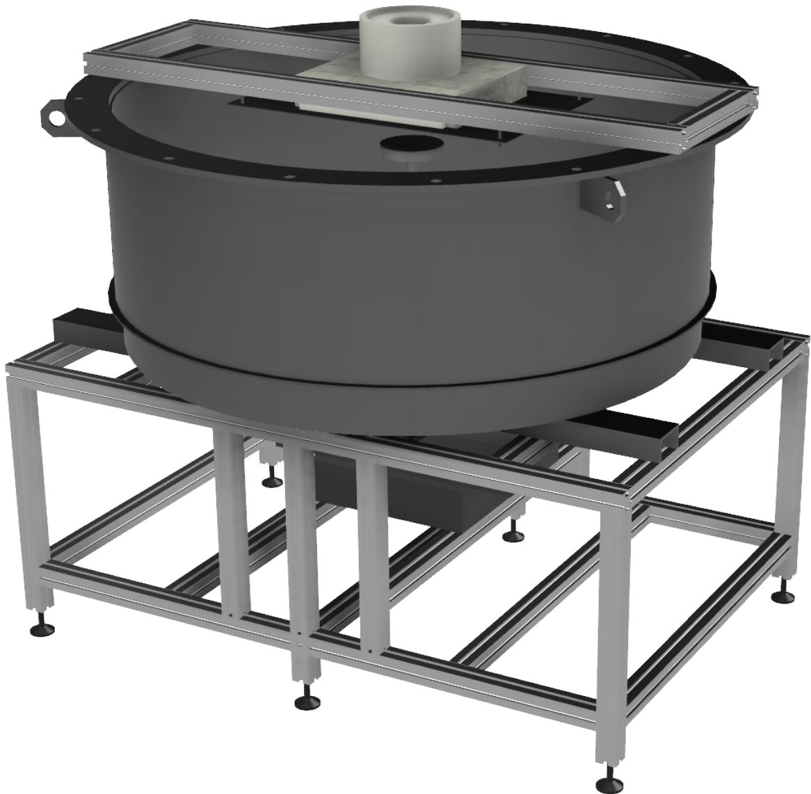
Abbildung 46: Visualisierung der finalen Rotationszerstäubungsanlage mit Fusion 360 .
