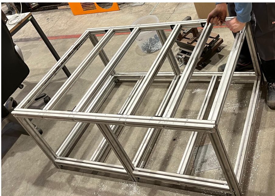
Abbildung 33: Fotografie der Unterkonstruktion des Rotationszerstäubers aus 40 mm Aluminium Konstruktionsprofilen.
