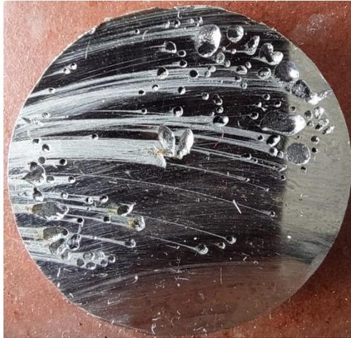
**Abbildung 6-1:** Poröse Probe der Versuchsserie 2
