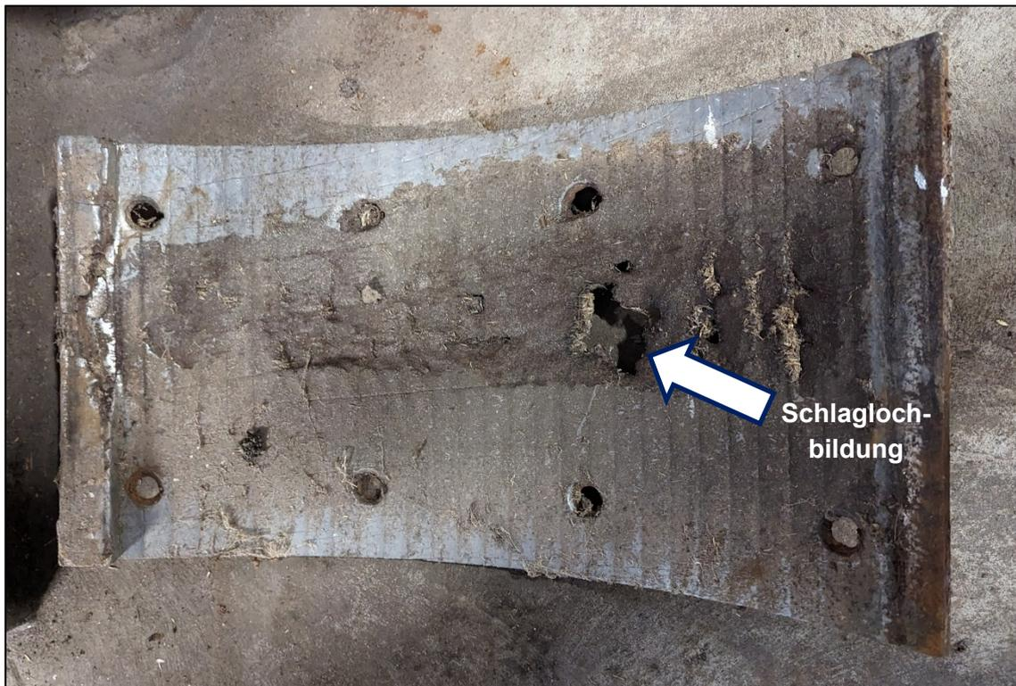
**Abbildung 12: Beispiel einer zerschlissenen Wandverkleidung (Eigene Darstellung)**
