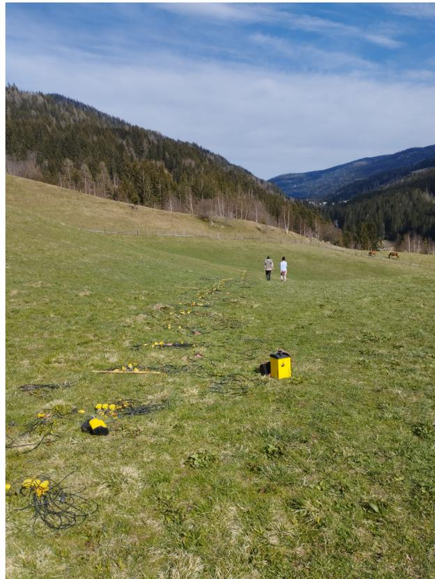
Abbildung 3.3: Compact-Unit für die Aufnahme von 24 Geophonen
