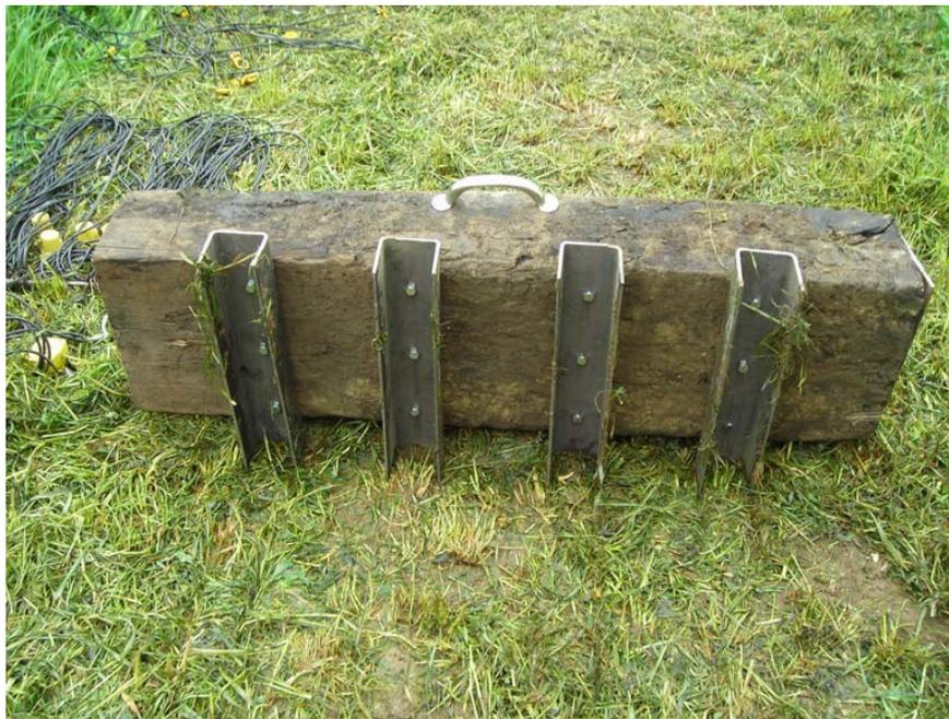
Abbildung 2.2: Unterseite Eggeplatte
