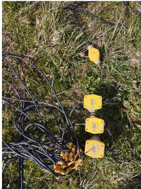
Abbildung 3.1: Geophonaufbau der P-Welleneinzelgeophone und 3er-Geophonketten für die S-Welle
