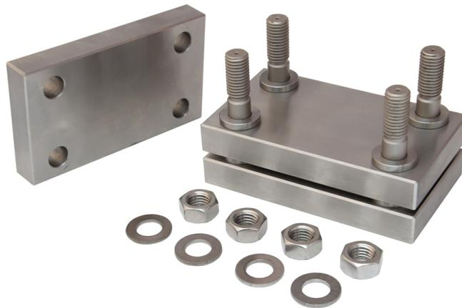
Abbildung 2.20: Beispiel einer Verformungsvorrichtung der Firma Grip-Engineering Thümmler GmbH für die Messung des Druckverformungsrestes [12].
