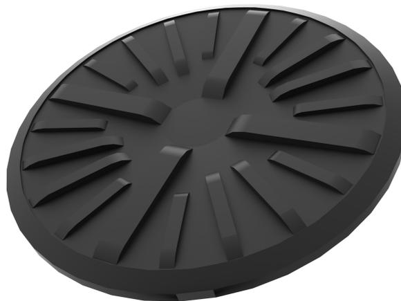
Abbildung 2.10: Darstellung einer charakteristischen Probe für RPA Messungen mit radial angeordneten Rippen zur Vermeidung von Wandgleiten [23].
