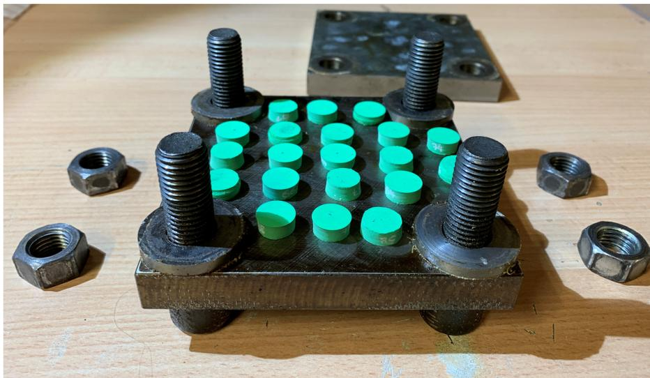
Abbildung 3.8: Abbildung der Positionierung der Prüflinge in der DVR-Messvorrichtung.
