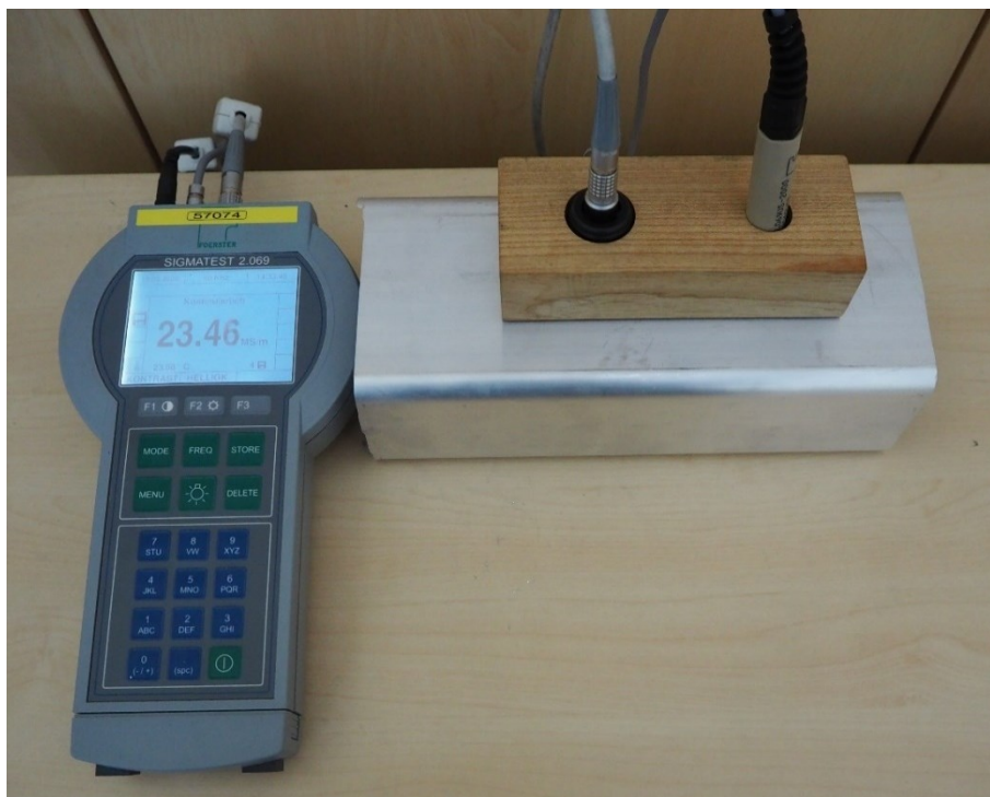
Abbildung 16: Messaufbau zur Aufnahme von LF-Kurven über einen beliebigen Zeitraum
