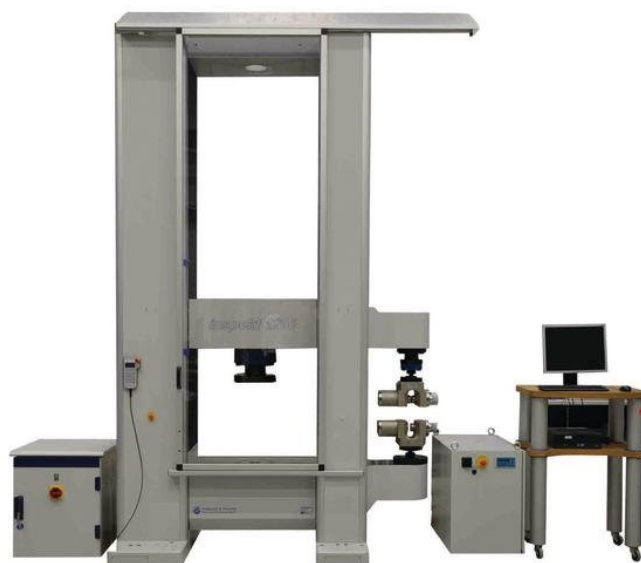
Abbildung 15: Universalprüfmaschine Inspekt 1200 der Firma Hegewald & Peschke [46]
