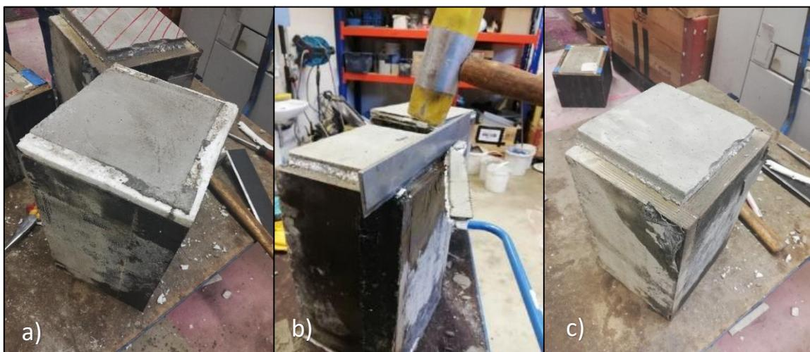
Abbildung 15 a) angehefteter Styroporstreifen an ausgehärteter Schnellspachtelmasse. b) Abtrennen der Styroporstreifen vom U-Profil der Probenschalung mittels Hammer und Abziehwerkzeug. c) gesäubertes U-Profil nach Abtrennen der Styroporstreifen.
