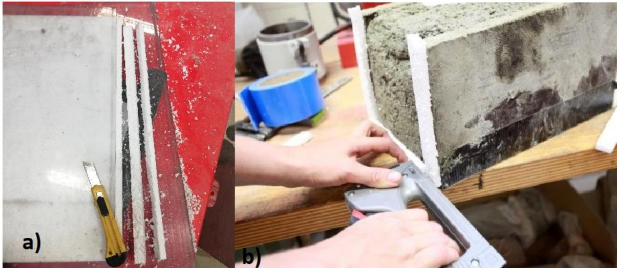
Abbildung 12a) Zurechtschneiden der Styroporstreifen (ca. 10 mm breit). b) Anbringen der Styroporstreifen an das U-Profil der Schalungen.
