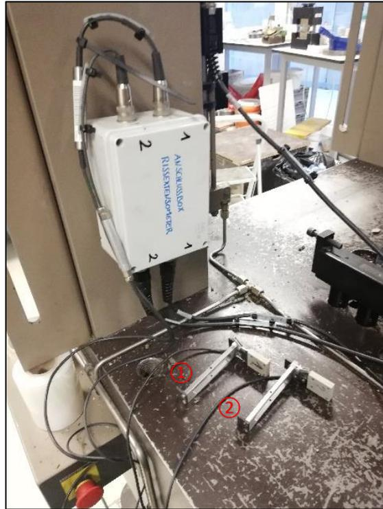
Abbildung 20 Anschlussbox der Dehnungsaufnehmer. ① und ②: Dehnungsaufnehmer.
