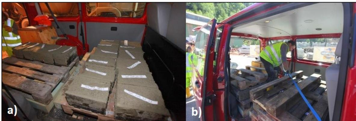
Abbildung 11a) frische Proben auf Europoolpalette mit untergelegter Schaumstoffmatte. b) Sichern der Proben durch Auflegen weitere Europoolpaletten und Spanngurte
