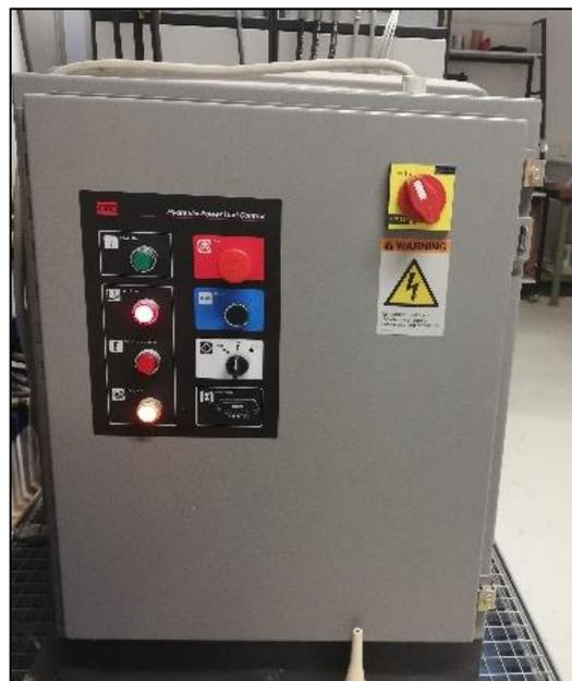
Abbildung 22 Hydraulik mit Einschaltknopf rechts oben (rot) und blauer „Reset“-Taste für das Zurücksetzen.
