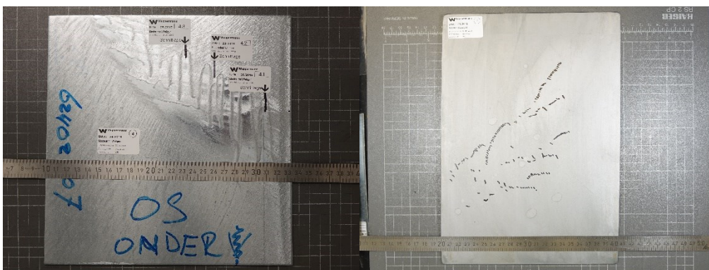
Abbildung 30: Lage der Schlitze der Probe 4 (links) und die makroskopischen Eindrücke nach dem Beizen von Probe 7 (rechts)
