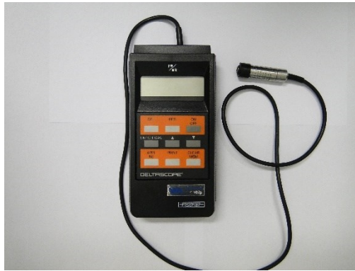
Abbildung 34: Das magnetinduktive Messgerät DELTASCOPE MP38/GA2H von Fischer
