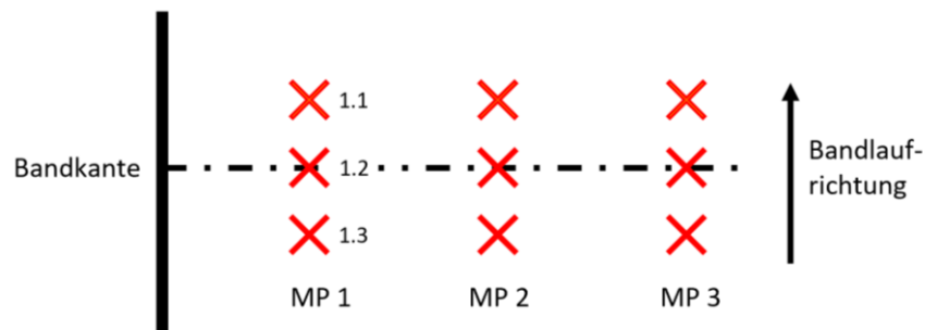
Abbildung 35: Die horizontal angeordneten Messpunkte (MP) unterteilen sich in jeweils drei vertikal ausgerichtete Einzelmessungen.
