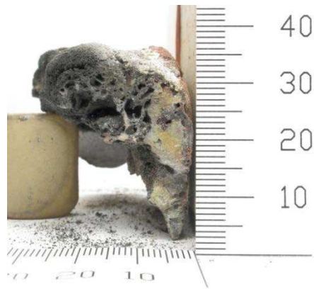
Abbildung 2-13: Stark poröse Krustenprobe.
