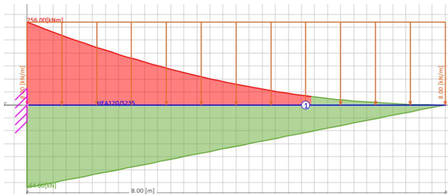
Abbildung 15. Querkraft- (grün) und Biegemomentenverlauf (rot) der Halterung
