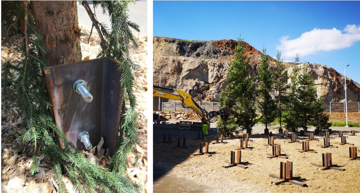
Abbildung 6. Aufbau und Einspannung der Fichten in den Halterungen
