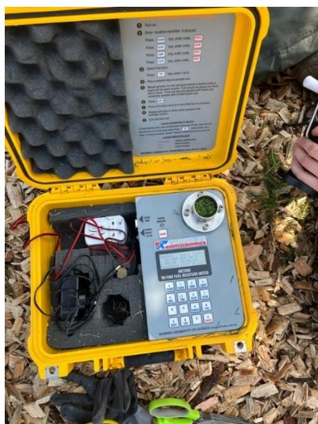
Abbildung 25. Messung des Feuchtigkeitsgehaltes der Nadeln mit dem ME2000A
