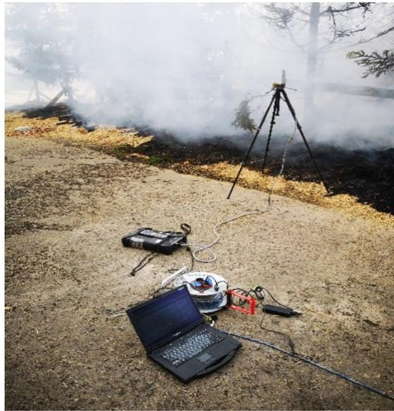
Abbildung 19. Testo 350 während des Versuches mit Analysebox und Control Unit
