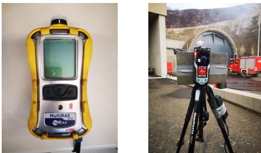
Abbildung 18 MultiRAE (links) und X-am 8000 (rechts) während des Brandversuchs
