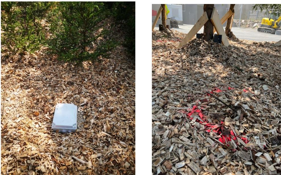
Abbildung 24. Datenlogger (links) und Temperatursonden (rechts)
