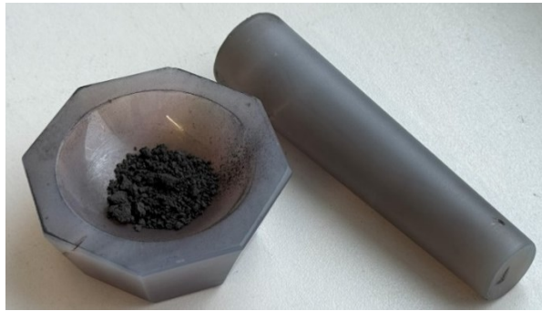
Abbildung 14: Zerkleinerung der hydrometallurgisch vorbehandelten Schwarzmasse aus der Metalllaugung
