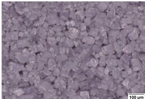
Abbildung 15: Kristalliner Niederschlag im Filtrat der Metalllaugung unter dem Digitalmikroskop
