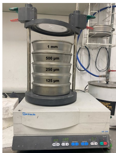
Abbildung 12: Siebturm: Siebschnitte bei Maschenweiten von 1 mm, 500 \mu\text{m} , 250 \mu\text{m} und 125 \mu\text{m}
