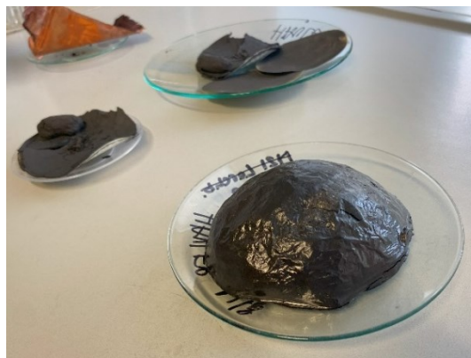
Abbildung 17: Probe C15 (vorne) aufgebläht aus dem Trockenschrank im Vergleich mit Proben ohne Auffälligkeiten beim Trocknen (hinten)
