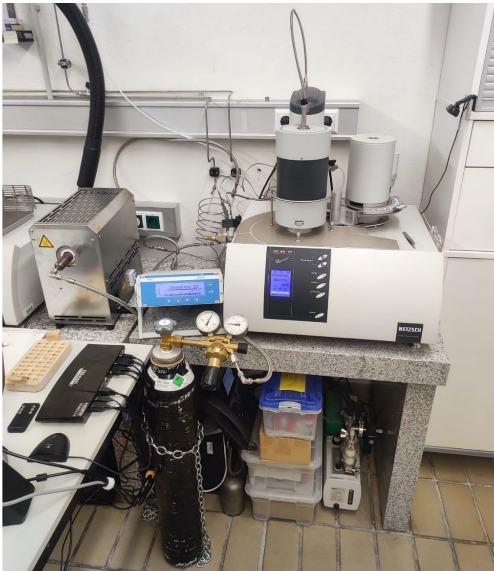
Abbildung 3-9: Versuchsaufbau zur Messung stickstoffhaltiger Proben an der DSC.
