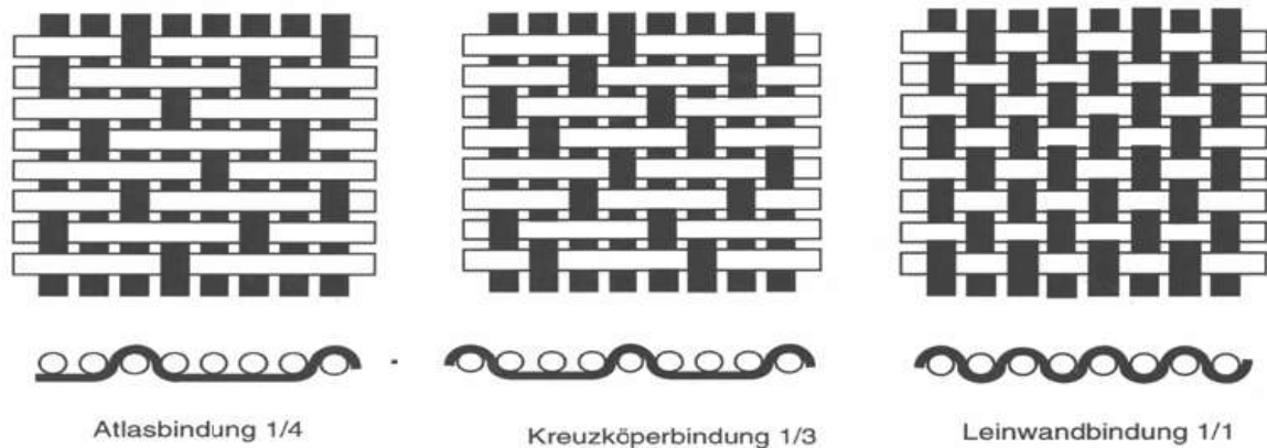
Abbildung 4: Gewebearten textiler Verstärkungsfasern [1]
