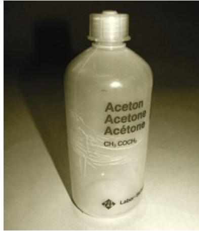
Abb. 2.7: Auftreten von umgebungsbedingter Spannungsrisssbildung bei einer PE-Flasche nach Gebrauch (Grellmann und Seidler 2011).
