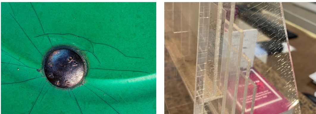
Abb. 2.8: Versagen durch umgebungsbedingte Spannungsrisssbildung bei Polymethylmethacrylat (Neogi und Zahedi 2013).
