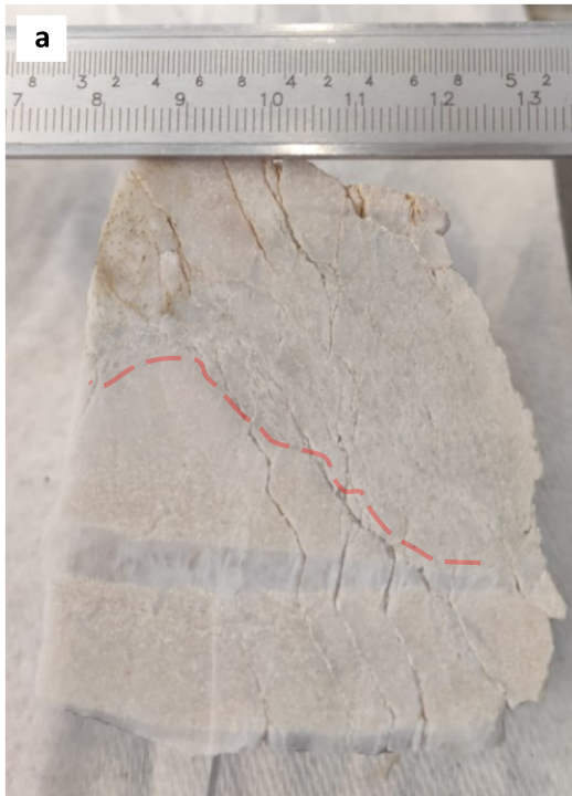
Abbildung 18: Diffus ausgebildete entfärbte Alterationszonen mit noch vollständig vorhandener glasiger Verheilung im Handstück. Die Kontaktzone weiß/grün ist strichliert angedeutet. a) Probe MZ-QZ-8B. b) Probe MZ-QZ-4B
