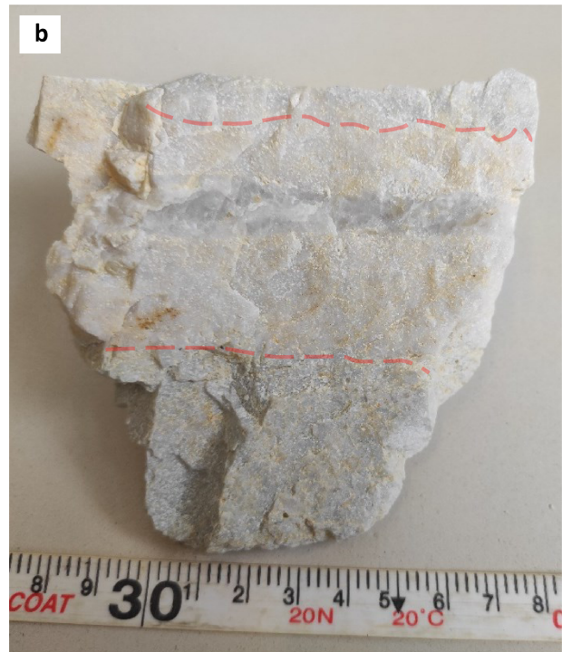
Abbildung 18: Diffus ausgebildete entfärbte Alterationszonen mit noch vollständig vorhandener glasiger Verheilung im Handstück. Die Kontaktzone weiß/grün ist strichliert angedeutet. a) Probe MZ-QZ-8B. b) Probe MZ-QZ-4B
