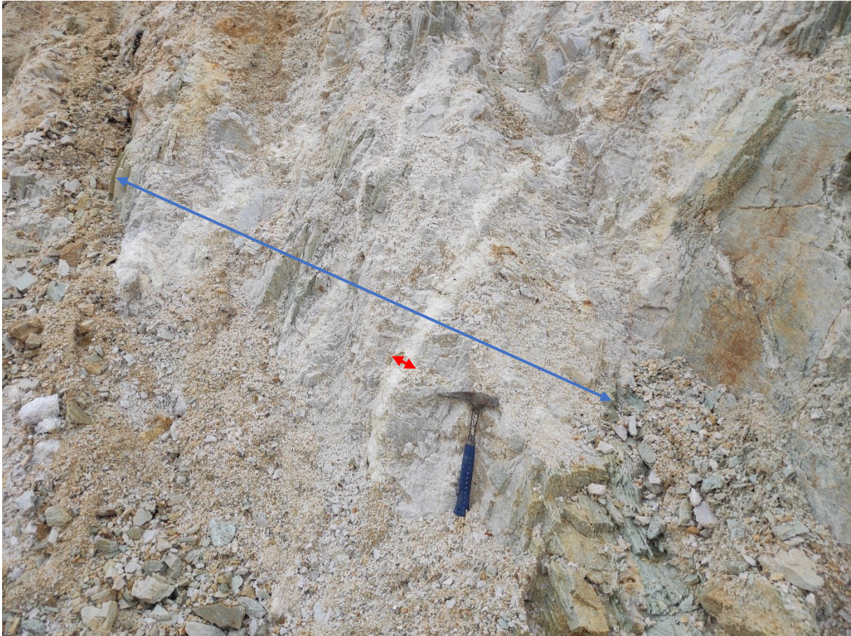
Abbildung 20: Kluft im grünen Quarzit auf ET 4. Der Alterationsbereich mit hochreinen weißen Quarziten erstreckt sich >1 m (blauer Pfeil). Die ehemals glasige Verheilung der Kluft ist vollständig vergrust (roter Pfeil).
