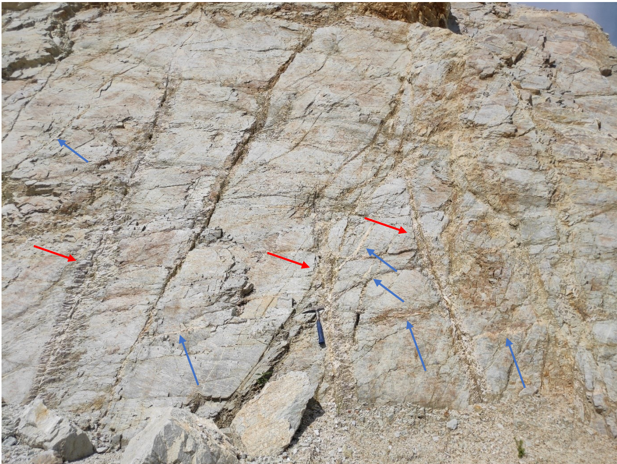
Abbildung 15: Bruchwand Metasandstein ET 1. Kluftarten im Metasandstein: a) Scharf abgegrenzt und mit Quarz verheilt (blaue Pfeile), b) Klüfte mit bis zu 20 cm breiten Alterationszonen (rote Pfeile). Blickrichtung normal zum Streichen in Richtung der Kluftchar 1.
