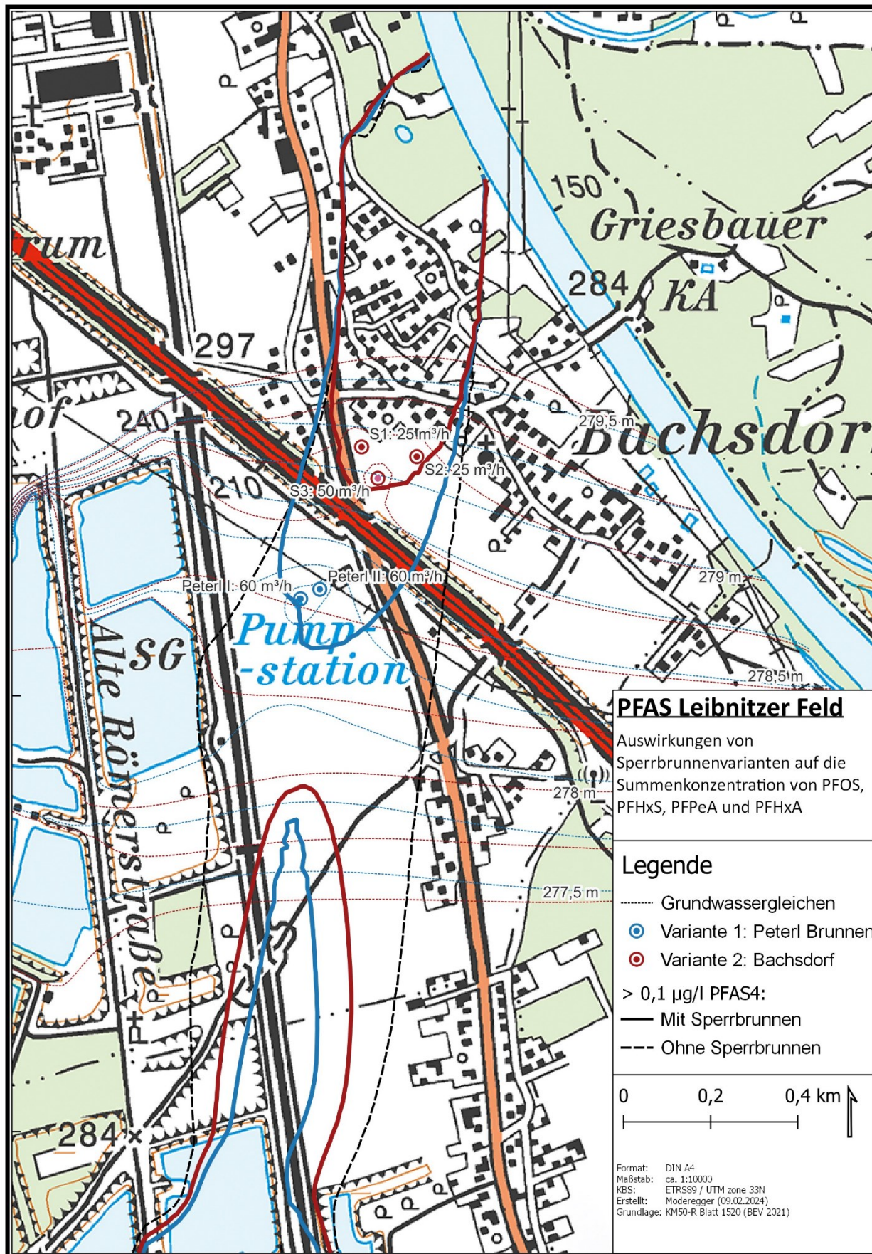
Abbildung 27: Auswirkungen von Sperrbrunnenvarianten nach einem Betriebsjahr auf die Summenkonzentration von PFOS, PFHxS, PFPeA und PFHxA.
