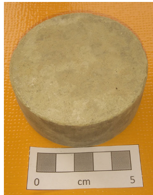
Abb. 3: Mineralwollebrikett bestehend aus Steinwolle und Bindemittel
