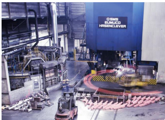
(a) 355 MN Spindelpresse mit Drehherdofen
