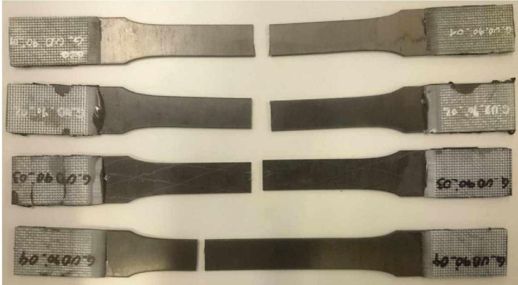
*Abbildung 61: Bruchverhalten von Prüfkörpern mit der Geometrie aus Designvorschlag 1 bei Ermüdungsversuchen.*
