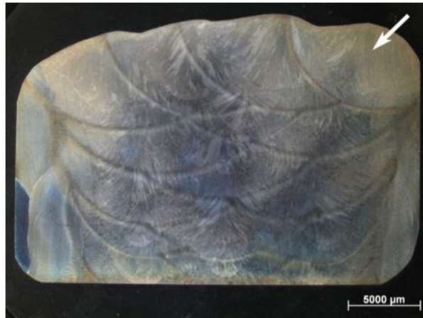
Abb. 17: Mit Pikrinsäure geätzter Querschnitt einer Mehrlagenschweißnaht, mit analogem Aufbau zu den, im Rahmen dieser Arbeit untersuchten, Schweißnähten [4].
