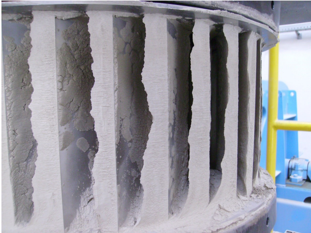
Abbildung 5-2: Anbackungen am Leitschaufelkranz
