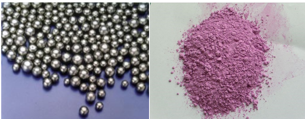
Figure 13: Les produits finis: Oxyde de nickel (gauche) et Carbonate de Cobalt (droite) (VALE.NC)
