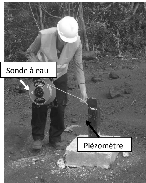
Figure 18: Mesure du niveau d'eau d'un piézomètre
