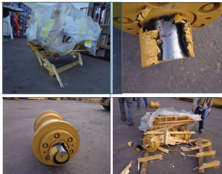
Abbildung 2: Verpackungsschaden - Räder C1505 Carajas 6
