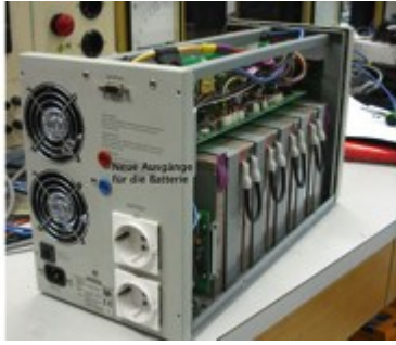
Abbildung 60: USV mit eingebauter aber nicht verwendeten Batterien (5 Stück 12 V je 7 Ah)
