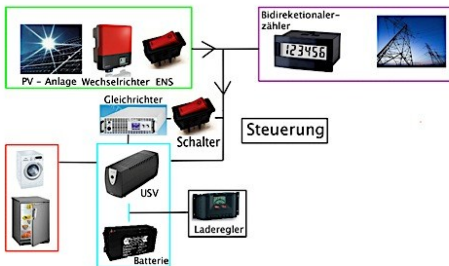
Abbildung 18: USV, Laderegler und Gleichrichter
