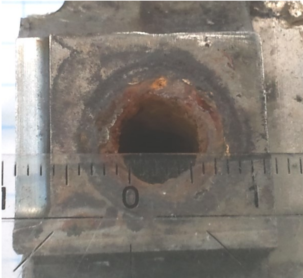
Abbildung 5: Ablagerungen im Kühlkanal (Kanaldurchmesser 10 mm).
