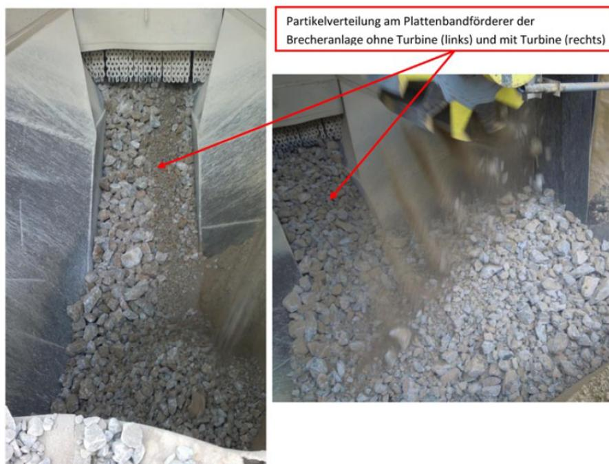
**Abbildung 18:** Durchmischungseffekt durch die Feststoffturbine [14]
