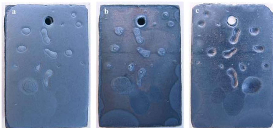
Abbildung 2-4: Blasenbildung nach 20-minütiger isothermer Oxidation einer TGA-Probe mit chemischer Zusammensetzung Nr. 2 in Tabelle 2-I bei 980^\circ\text{C} ; (a) Äußere Oberfläche der
