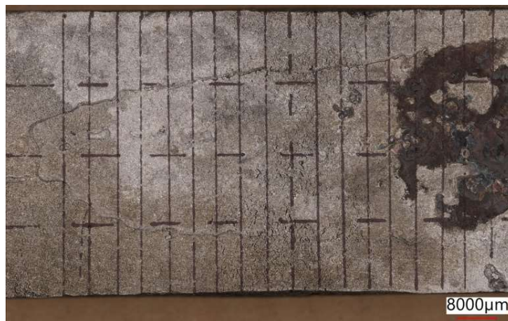
Abbildung 4-8: Panoramaaufnahme Probe LC_25Cu03Sn Biegetemperatur: 1100 °C
