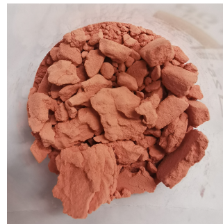
f) Beschaffenheit der Probe von Versuch G_110_6_10 während des Lockerungsschritts
