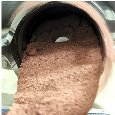
c) Durch Rütteln gelockerte Schüttung
