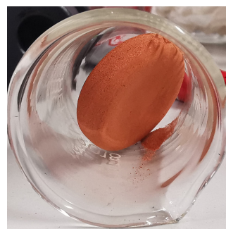
f) Beschaffenheit der Probe von Versuch NG_200_24_3 nach dem Lockerungsschritt
