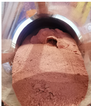
c) Durch Rütteln gelockerte Schüttung
