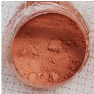
e) Beschaffenheit der Probe von Versuch G_90_1_10 nach dem Lockerungsschritt
