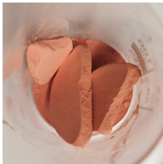
c) Beschaffenheit der Probe von Versuch G_{200\_1\_10} nach dem Lockerungsschritt
