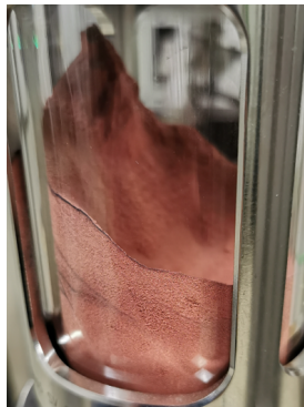
a) Aufgetürmte Schüttung der Wirbelschicht nach dem Stillstand
