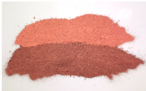
Abbildung 4.5: Vergleich der Ergebnisse der Wirbelschichtversuche 1 und 2 mit H_2 (oben) und CO (unten) als Reduktionsmittel.
