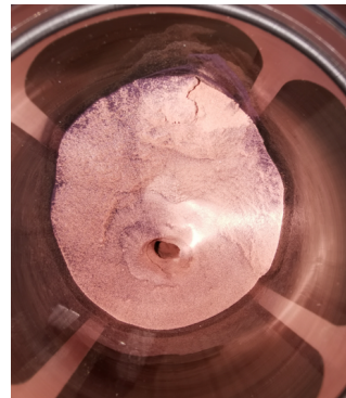
b) Draufsicht der aufgetürmten Schüttung der Wirbelschicht nach dem Stillstand
