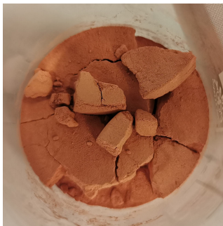
e) Beschaffenheit der Probe von Versuch G_130_1,5_10 während des Lockerungs- schritts
