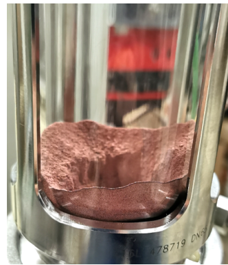
b) Seitenansicht der aufgetürmten Schüttung der Wirbelschicht nach dem Stillstand
