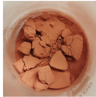
f) Beschaffenheit der Probe von Versuch G_90_24_10 während des Lockerungsschritts
