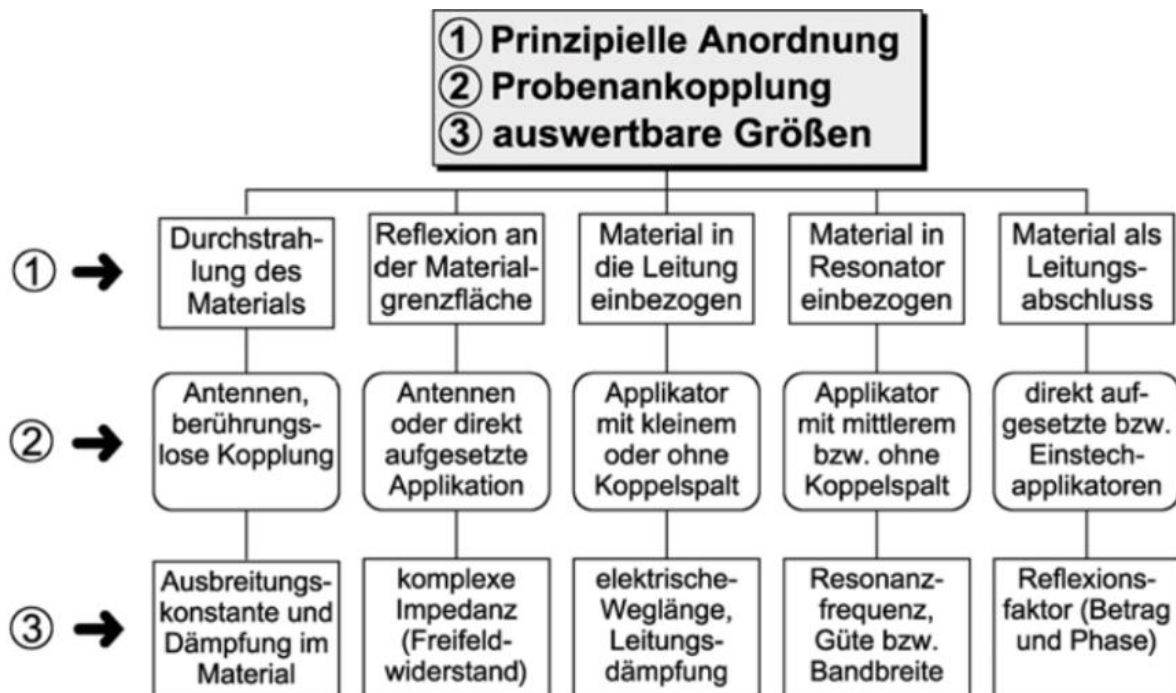
Abbildung 2-4: Anordnungen der Feuchtemessung bei Transmission, Reflexion und Resonanz. [8]
