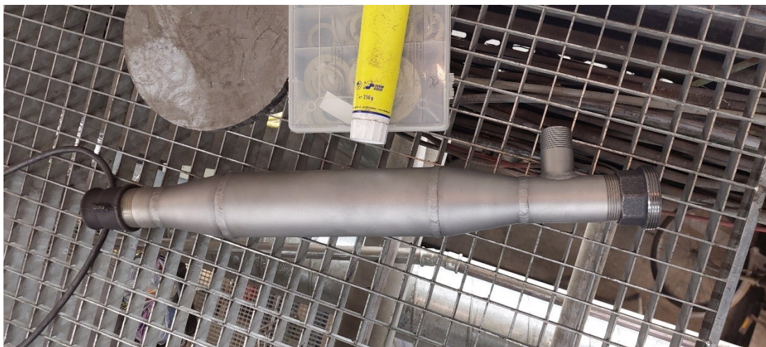
Abbildung 32: Statischer Mischer für die Mischung von Methan und Wasserstoff
