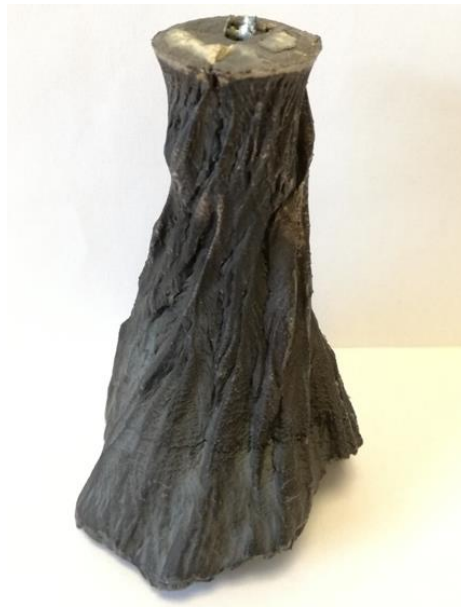
Abbildung 33: Düsenspritzguss aus dem Werkstoff W722.
