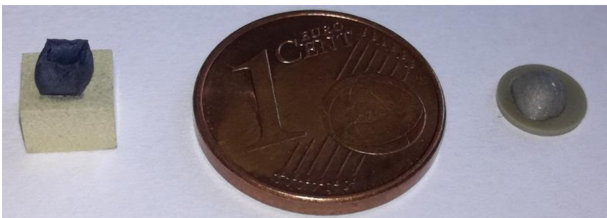
Abbildung 77: L334, aufgeschmolzen mit dem Laser-Konfokalmikroskop; links: L334 auf Z95; rechts: L334 auf einer Scheibe aus dicht gesintertem ZrO 2 .
