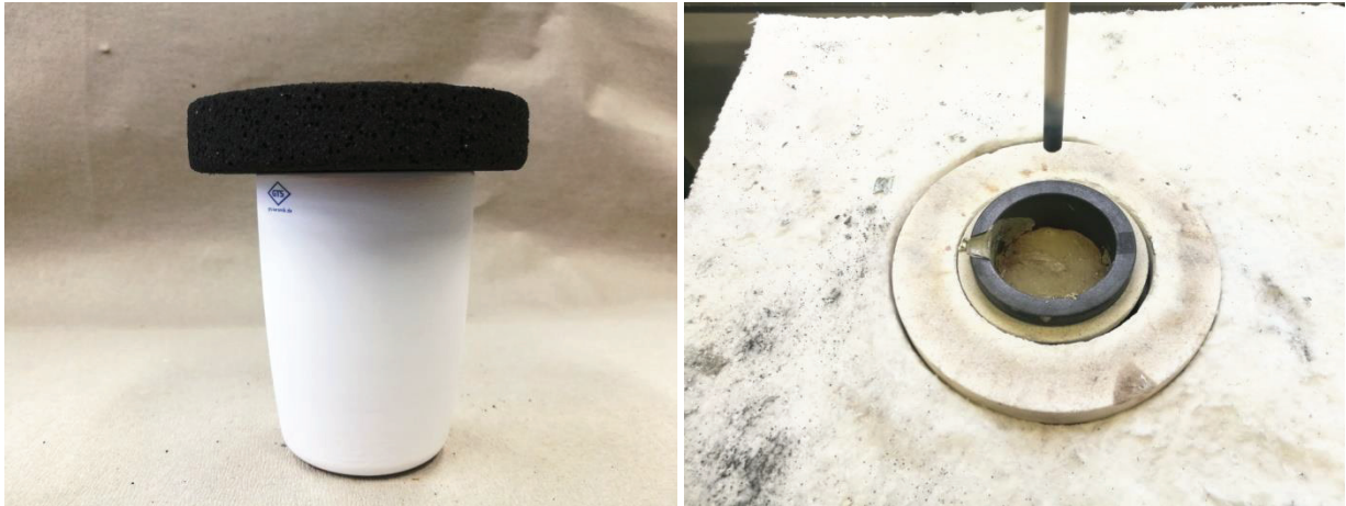
Abbildung 12: Tiegel mit Graphitabdeckung (links) und Zinkschmelze unter Argonspülung (rechts)
