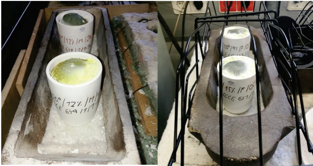
Abbildung 14: Abkühlen der Probe an der Luft ohne (links) und mit Schutzkäfig (rechts)
