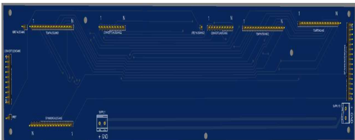
Abbildung 4-32: 3D Ansicht Verteilerplatine
