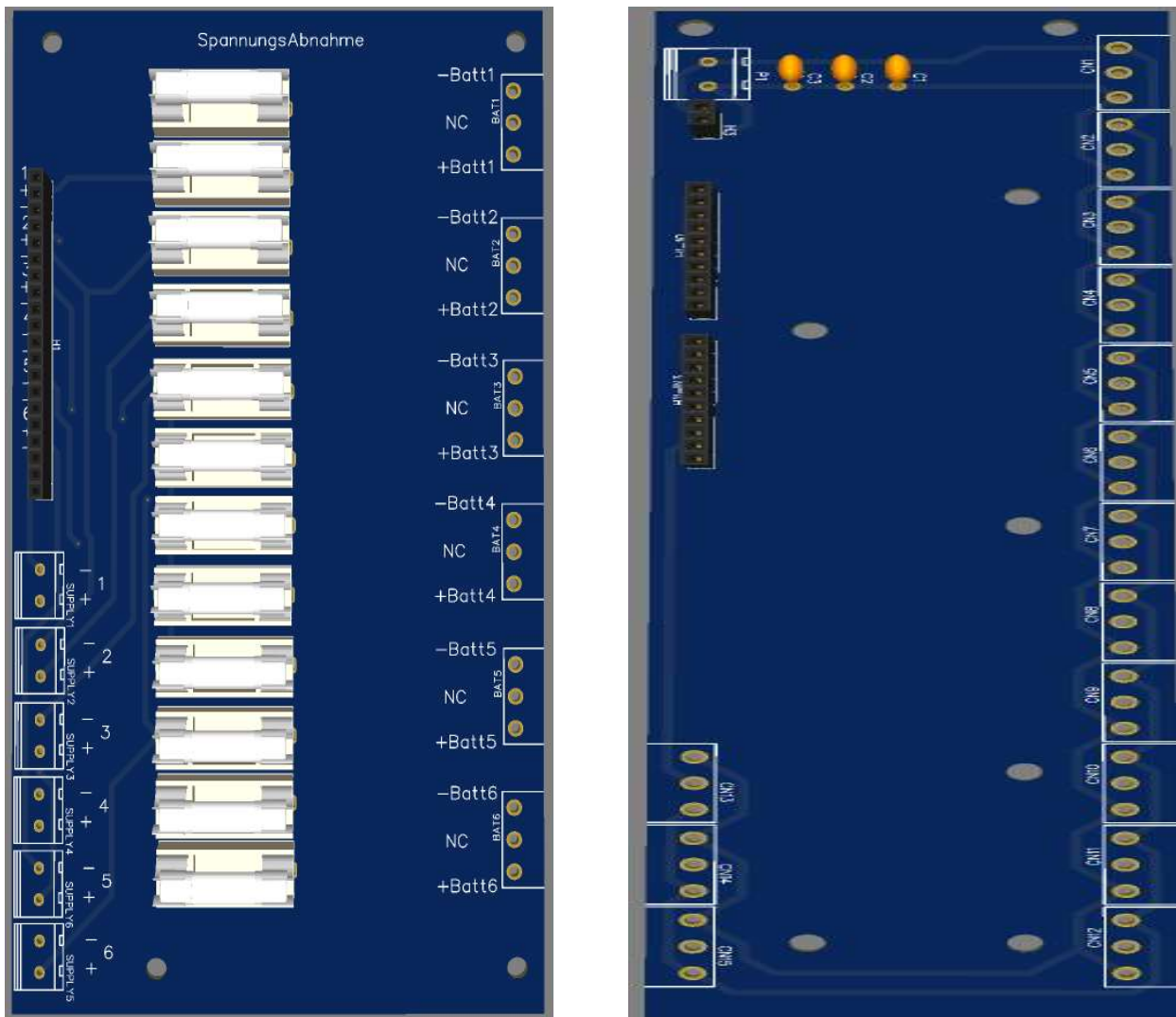
Abbildung 4-31: 3D Ansicht Zellenspannung Zuleitung(links) Temperaturerfassung(rechts)
