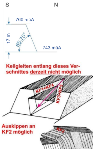
Abbildung 12: Kluftaufnahme und mögliche Versagensmechanismen, Etage 743 müA Süd, Blickrichtung Süd (Doppler 2017)
