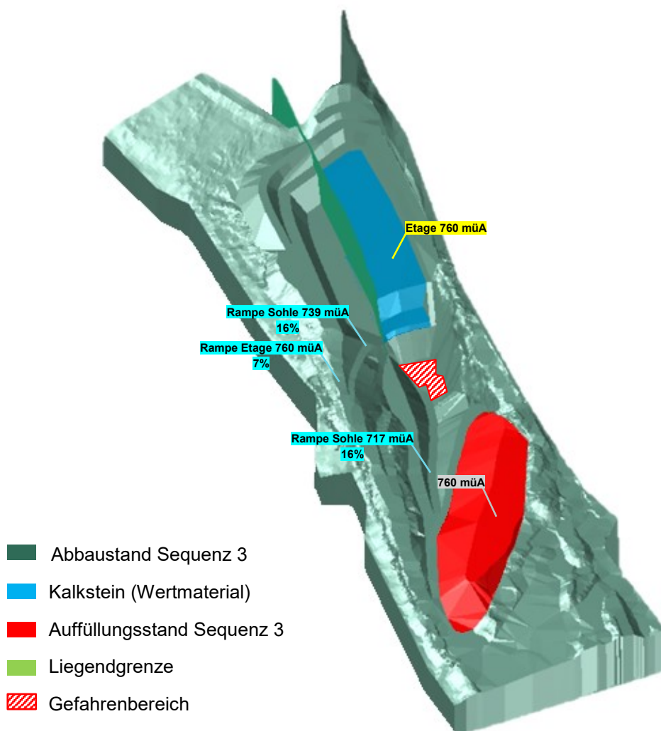
Abbildung 50: Abbau- und Auffüllung Sequenz 3, Variante 3
