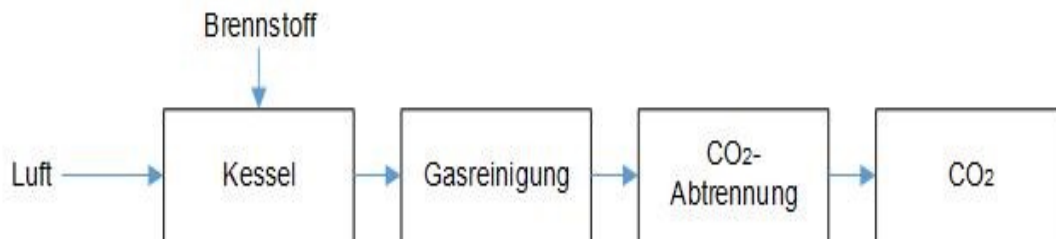
Abbildung 3-8: Vereinfachtes Schema des Post-Combustion-Verfahrens zur CO 2 -Abscheidung
