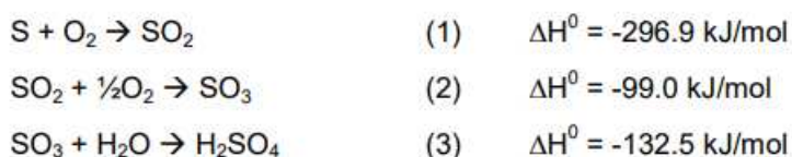
Abbildung 8: Reaktionsschritte bei der Schwefelsäureherstellung [36]
