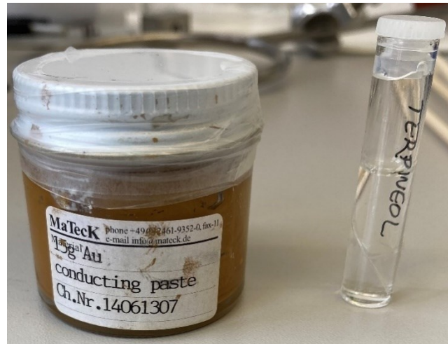
Abbildung 63: Goldkontaktpaste der Fa. MaTeck und Terpeneol zur Verdünnung.
