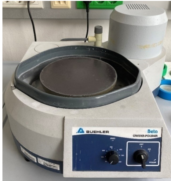
Abbildung 50: Schleifmaschine „Beta Grinder Polisher“ der Fa. Buehler.
