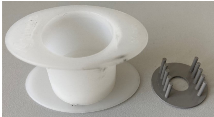
Abbildung 82: Links: Einbettform ( d = 30 \text{ mm} ); Rechts: Probenhalter.
