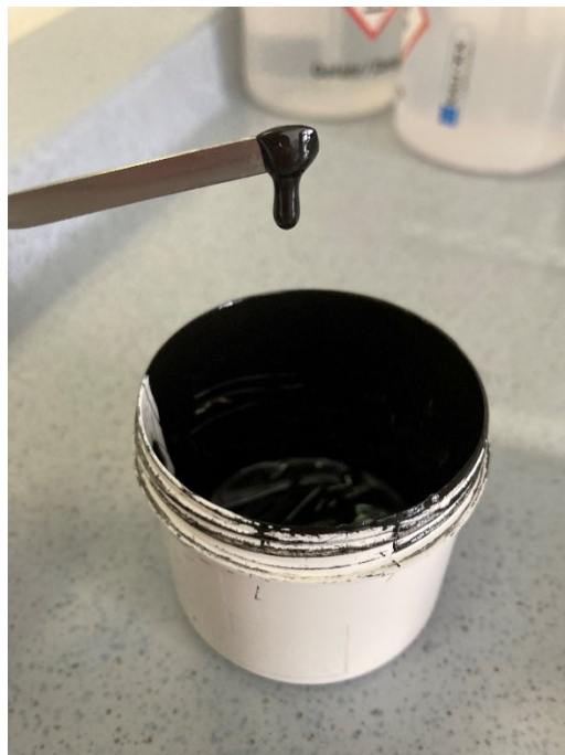
Abbildung 59: LNCO282-Paste mit 16 m% PVB-Vehikel
