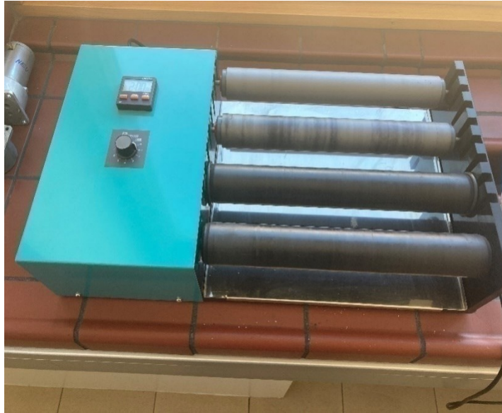
Abbildung 42: Rollbank für das Mahlen von Pulvern.
