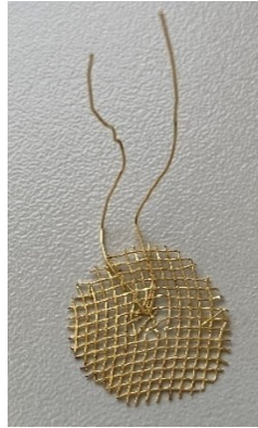
Abbildung 79: Goldnetz für die Kontaktierung der Zellen-Oberseite.
