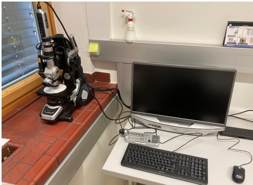
Abbildung 52: Digitales Lichtmikroskop VHX 970F Digital Microscope der Firma Keyence.
