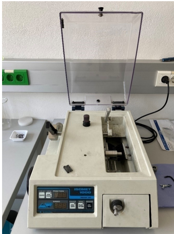
Abbildung 85: Säge „ISOMET 1000“ von Buehler.
