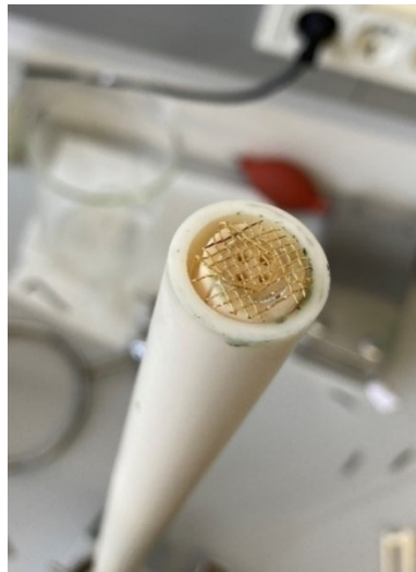
Abbildung 80: Eingebautes Goldnetz für die Kontaktierung der Zellunterseite.
