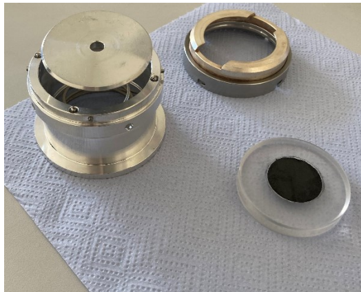
Abbildung 40: XRD-Probenhalter und Kunststoffprobenträger aus Kunststoff mit LNCO282-Pulver.
