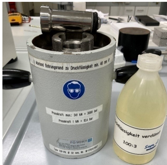
Abbildung 48: Pressform und Druckflüssigkeit für die isostatische Presse (Fa. Weber).
