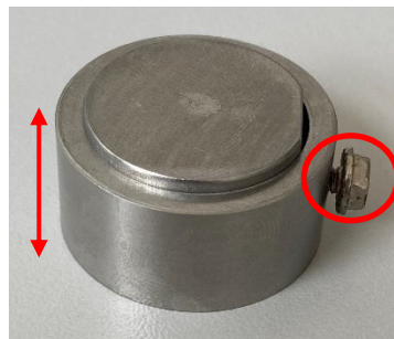
Abbildung 55: Probenhalter für das Polieren von GDC-Elektrolytsubstraten
