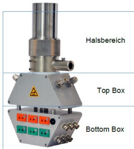
Abbildung 90: Grundkörper des verwendeten ProboStat zur Aufnahme von I/U-Kennlinien [109, 120].
