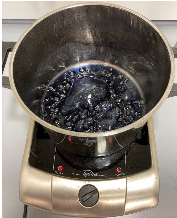
Abbildung 36: Bildung einer gelartigen Substanz nach dem Verdampfen des Großteiles von Wasser bei der Synthese von \text{LNCO282} .
