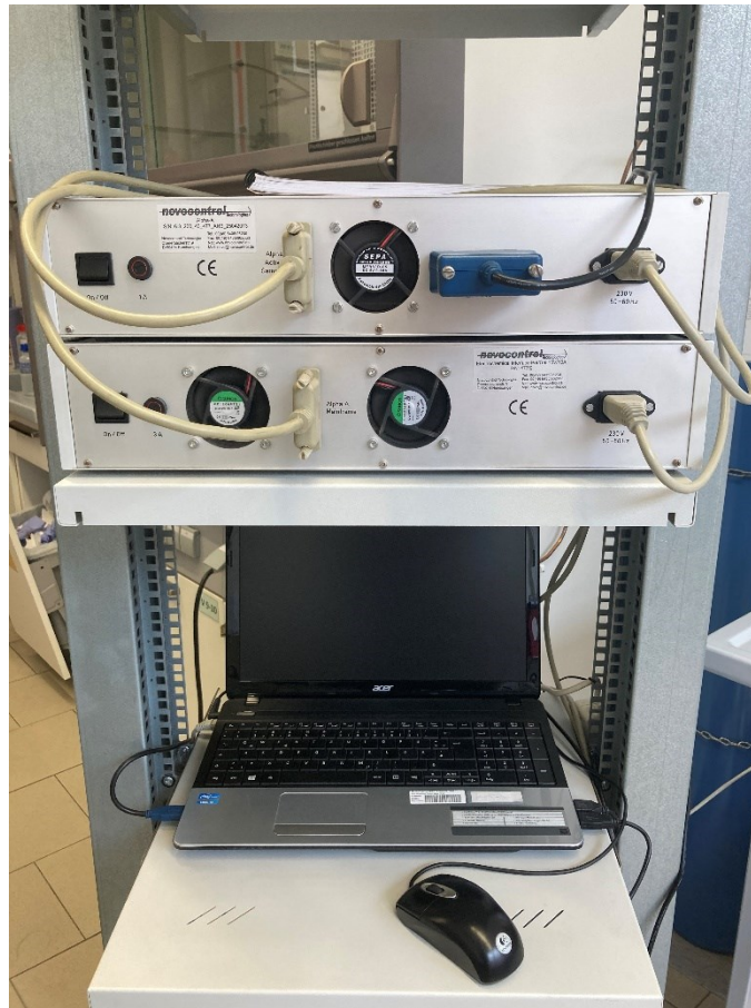
Abbildung 76: Verwendete Messgeräte (oben: Novocontrol Alpha-A Frequency Analyzer; unten: Novocontrol Electrochemical Interface Pot/Gal 15 V/10 A) mit Steuerrechner.
