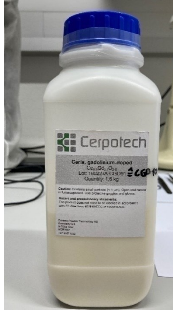
Abbildung 43: Gadolinium-dotiertes Ceroxid der Firma Cerpotech.
