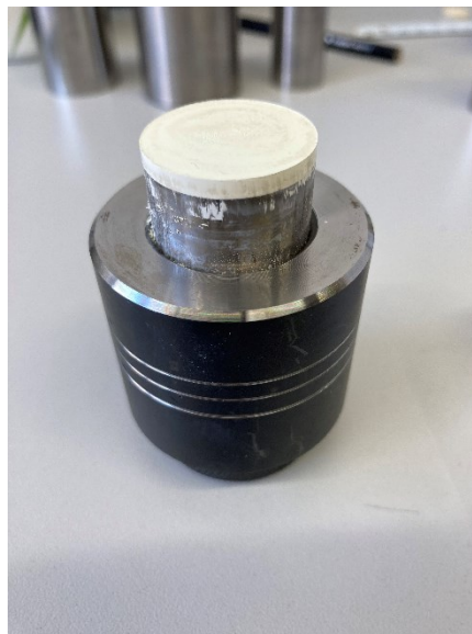
Abbildung 45: Uniaxial verpresstes GDC-Elektrolytsubstrat mit verwendeter Pressform.
