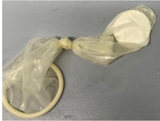
Abbildung 47: Uniaxial verpresstes GDC-Elektrolytsubstrat in einem Kondom.
