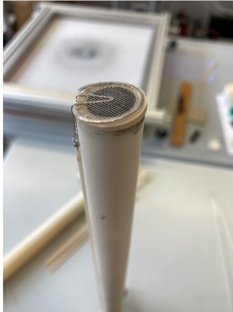
Abbildung 73: Kontaktierte Zelle auf einem Stützrohr aus Aluminiumoxid.
