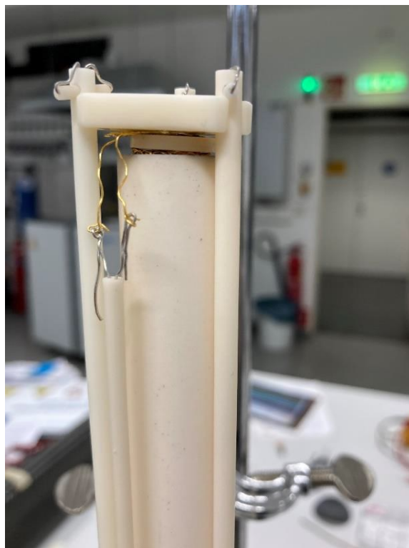
Abbildung 75: Fixierte und kontaktierte Zelle am oberen Ende des Stützrohres.
