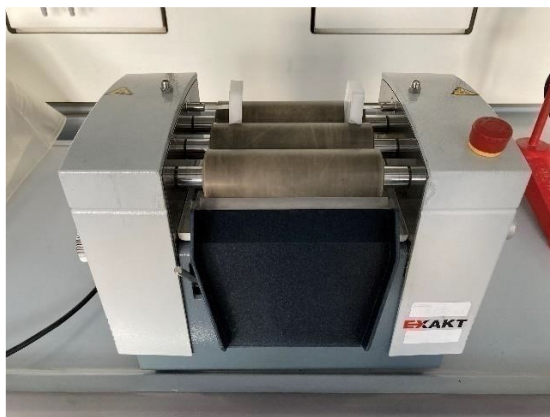
Abbildung 58: Dreiwalzenstuhl mit Aluminiumoxidwalzen der Firma Exakt.
