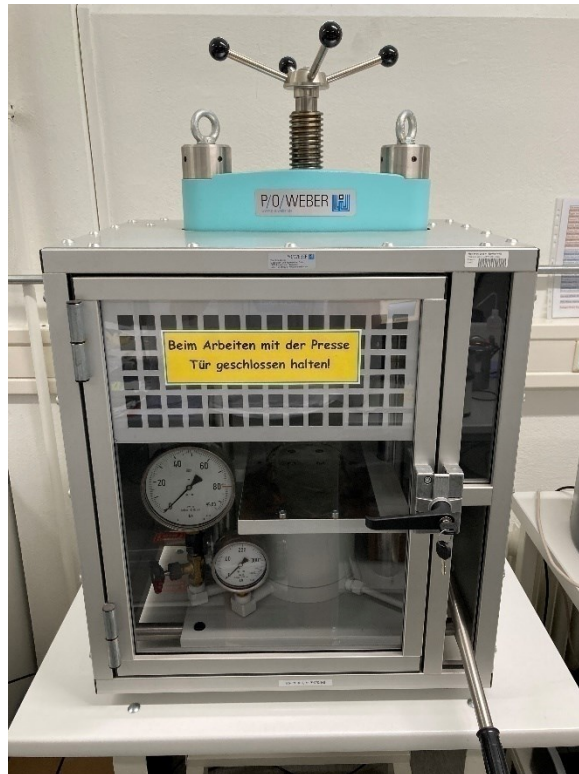
Abbildung 49: Isostatische Presse des Herstellers Weber.
