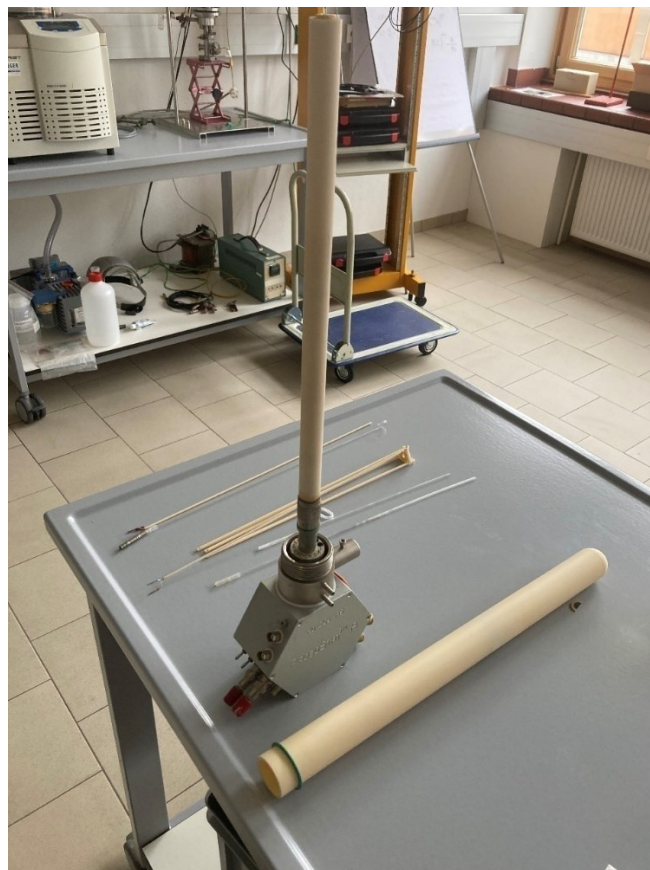
Abbildung 71: ProboStat mit montiertem Stützrohr und weiteren Komponenten.
