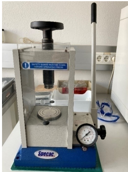
Abbildung 44: Uniaxiale Presse des Herstellers Specac.
