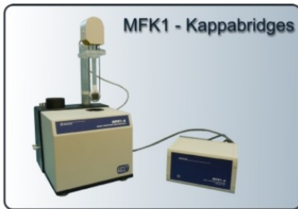
Abb. 4.38: Die MFK1 Kappabridge mit der die manuelle Messung der Suszeptibilität in 15 Richtungen erfolgte (Agico, 2011).
