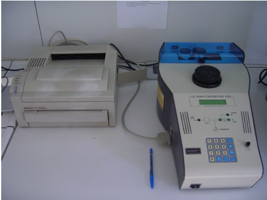
Abb. 4.10: Das für die Messung verwendete Ultrapyknometer 1000 der Firma Quantachrome Instruments.
