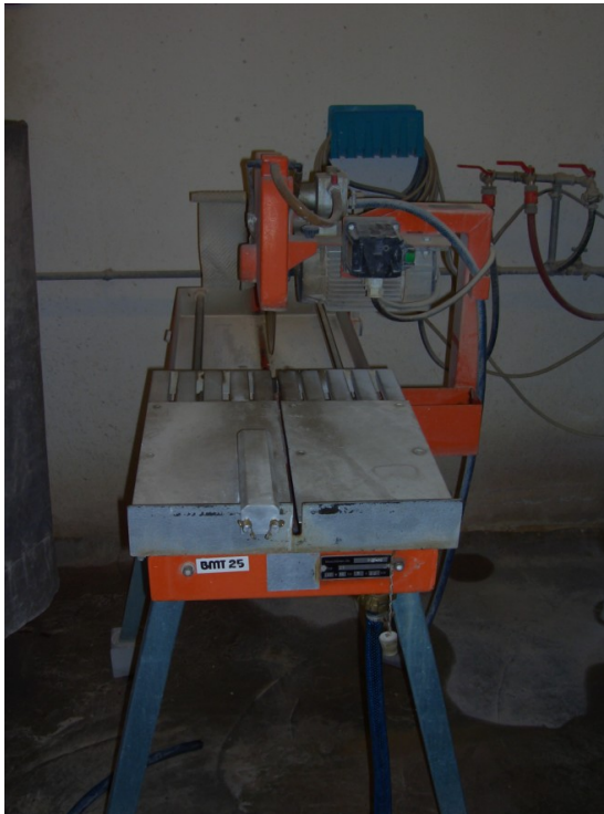
Abb. 4.4: Im linken Bild ist die verwendete Gesteinssäge und im rechten der Gesteinsbohrer mit einem Innendurchmesser von 2,5 cm zu sehen.
