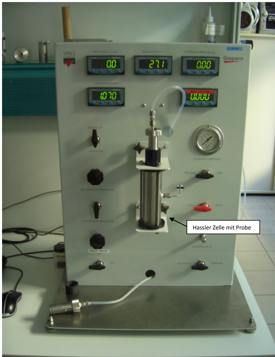
Abb. 4.22: Das im Petrophysiklabor der Montanuniversität Leoben verwendete Stickstoff-Permeameter.
