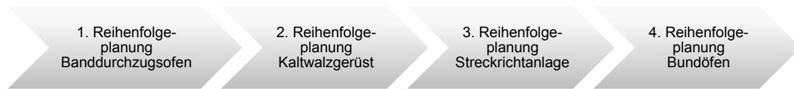
Abbildung 56: Reihenfolge der Anlagenreihenfolgeplanung im Kaltwalzwerk
