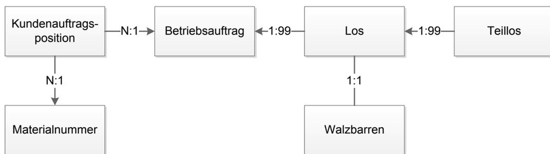
Abbildung 51: Entity-Relationship Diagramm eines Betriebsauftrages
