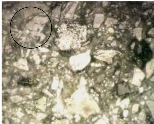
**Abbildung 14: Auflichtmikroskopische Darstellung der Cuspidinbildung mittels HTM**
