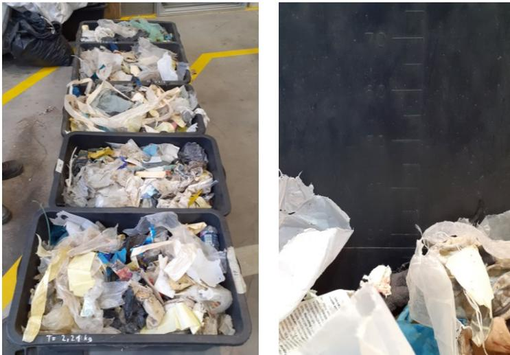
Abbildung 41: Bildaufnahme der befüllten Mörtelkästen zur Durchsatzbestimmung (links) und der zur Bestimmung des Volumens verwendeten Skala in einem Mörtelkasten.
