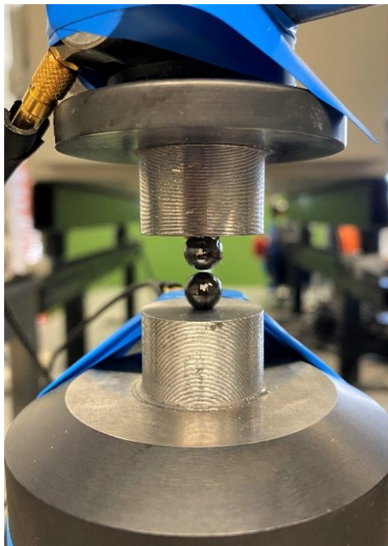
Abbildung 11: Versuchsaufbau für die Untersuchung der Kontaktschädigung von \text{Si}_3\text{N}_4 -Kugeln mittels eines Kugel-Kugel-Drucktest
