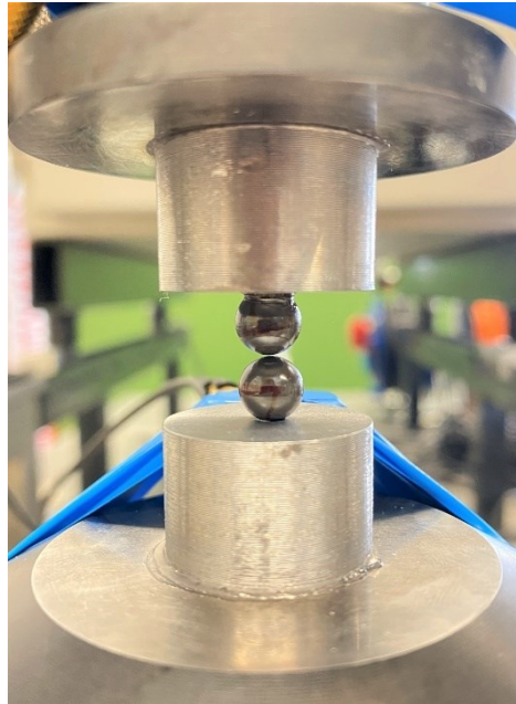
Abbildung 27: Kontaktschädigung mittels Kugel-Kugel-Kontakt der \text{Si}_3\text{N}_4 -Kugeln mit d = 8,7 mm
