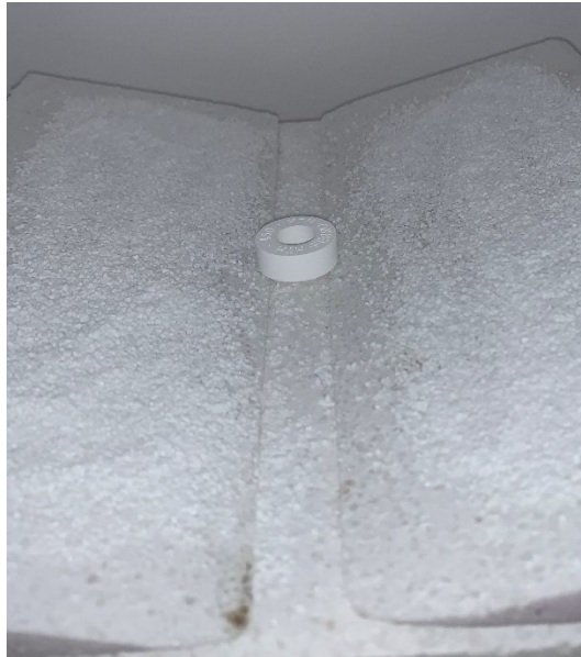
Abbildung 19: Darstellung des Sintergranulats und des Prozess-Temperatur-Kontrollrings im Hochtemperaturofen für den Post-Processing-Schritt „Sintern“. Zusätzlich erkennt man die Sinterkeile mit einer Neigung von 15° für das Sintern der Prüfkörpertypen B1 und B2.
