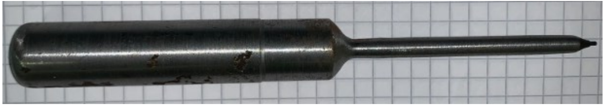
Abbildung 25: Darstellung des Prüfdorns, das rechte Ende dieses Dorns wurde für die Belastung der einzelnen Biegebalken verwendet. Der hintere Teil wurde so gefertigt, dass der Prüfdorn in die vorhandene Vorrichtung der Kraftmessdose integriert werden kann.
