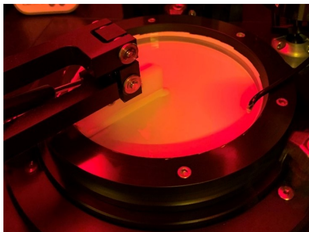
Abbildung 66: Darstellung der Dosierung des Schlickers in der Schlickerwanne. Im linken Teil des Bildes erkennt man die Rakel, welche ein gleichmäßiges Schlickerbad erzeugt.
