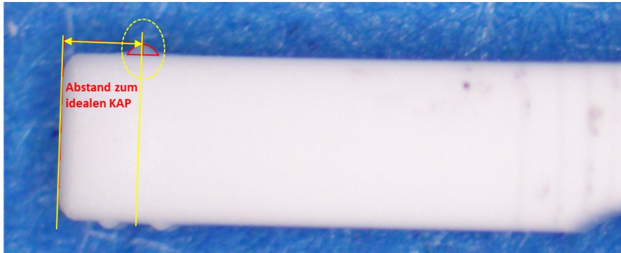
Abbildung 58: Ermittlung des idealen KAP mit der Vermessung in Stream Motion. Die gelbe Bemessung kennzeichnet den Abstand zwischen der Vorderkante des Biegebalkens zum gedruckten KAP.
