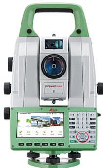
Abbildung 4- Leica Totalstation TS60 [7]
