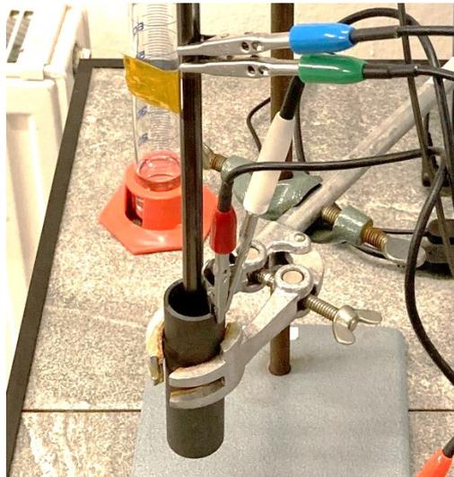
Abbildung 27: Aufbau zur Bestimmung der Zellkonstanten (Klemmen: grün-Arbeits Elektrode, blau-Potentialmessen Elektrode der Arbeits Elektrode, rot-Gegenelektrode, weiß-Referenzelektrode)
