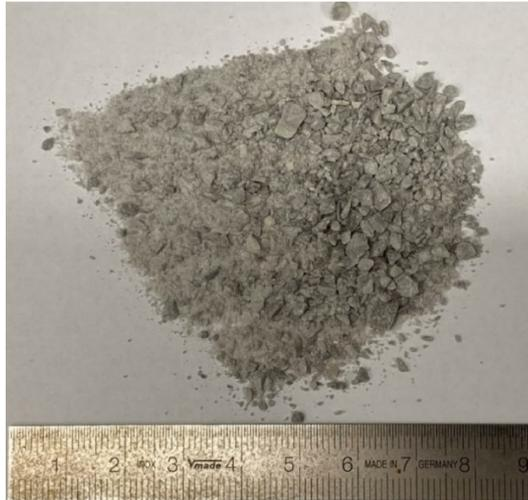
Abbildung 23: Gebrochene Probe der ESU-Schlacke "ESR 2015" (Backenbrecher; Brechspalt 2 mm)
