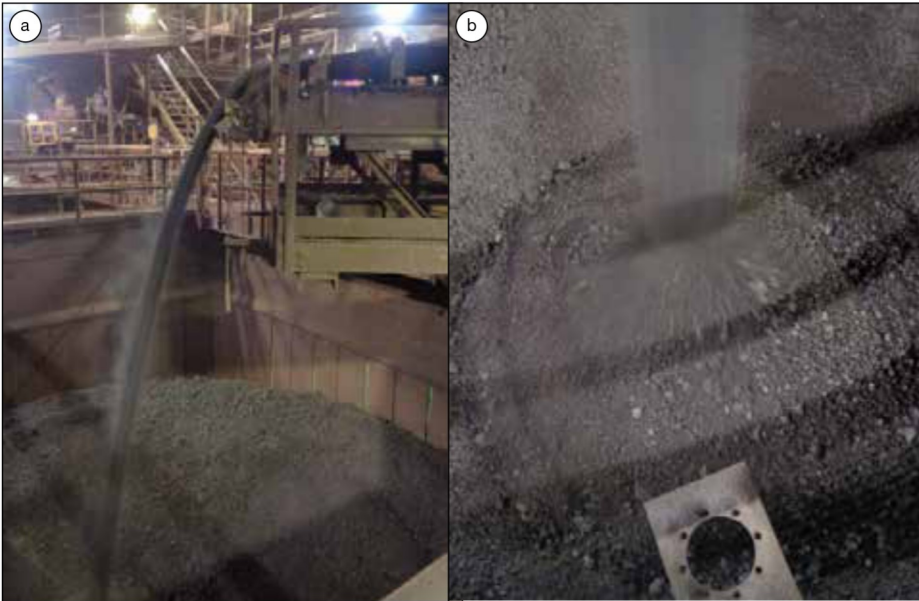
Bild 1: a) Befüllung eines Sinterbunkers mittels Gurtbandförderers [5] b) Grobkörniges Material an den äußeren Zonen des Schüttguthaufens [6]
